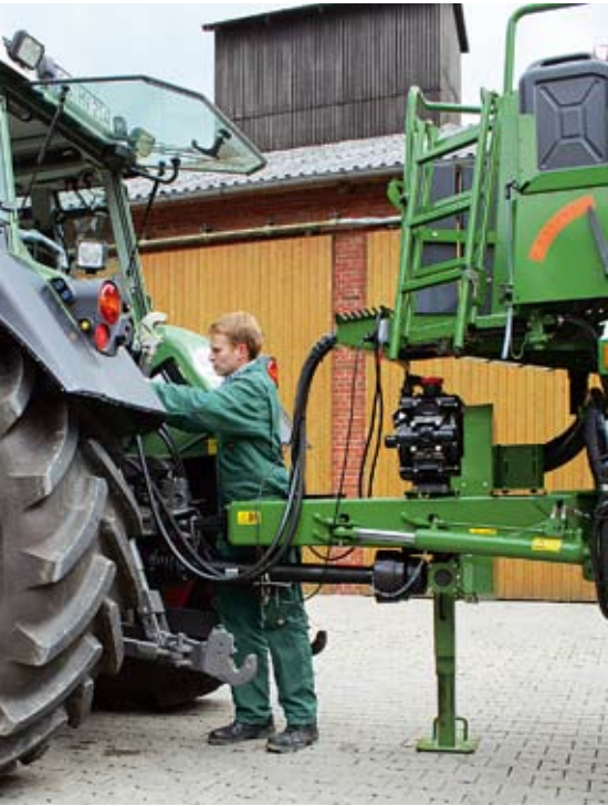
Das Hochdrehen der Kurbelstütze braucht Zeit (hydraulische Stütze auf Wunsch).
