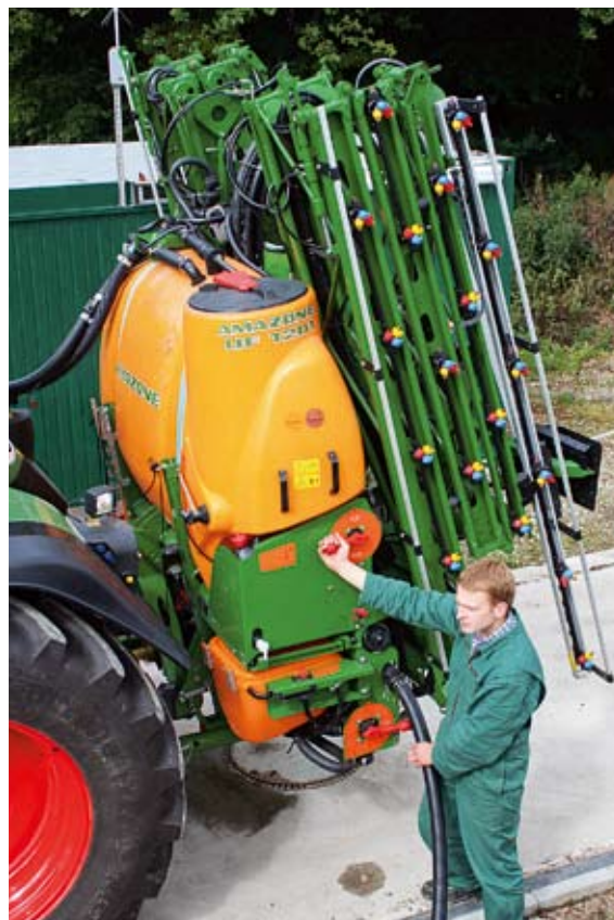
Beim Befüllen der Front-Heck-Kombi steuert der Rechner den Flüssigkeitsstrom automatisch.
