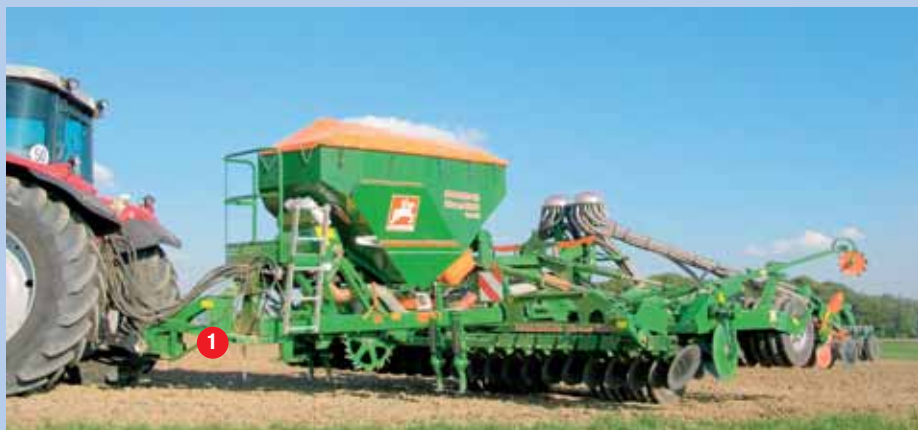
Am Vorgewende kann die Cirrus über den gesamten 6-m-Packer oder über das 2x80 cm Reifenpaket (Foto) ausheben. Die Wendigkeit ist dank des zurückgesetzten Drehpunkts (1) gut. Für die Straße gibt's die 40 km/h-Freigabe.
