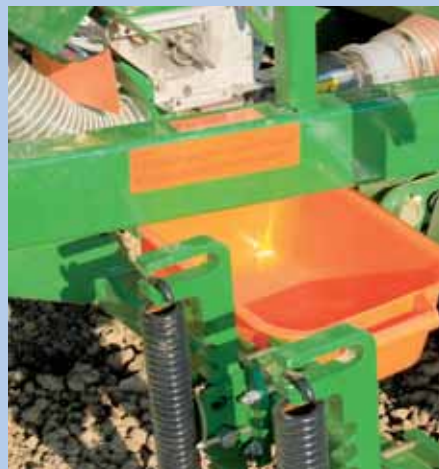
Gut gelöst: Die Abdrehwannen können auf Schienen unter den Dosierer geschoben werden. Die Ausbringgenauigkeit ist gut.
