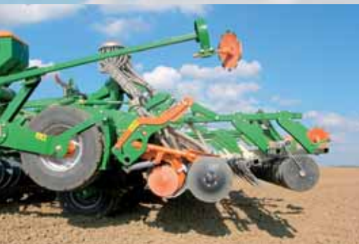
RoTec+ Schare: Die 400-mm-Scheiben aus Borstahl laufen 40 cm hintereinander. Maximal 50 kg Scharndruck sind drin. Dieses Maß reicht für mittelschwere Standorte.
