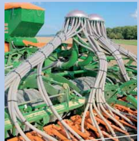
Die beiden Verteilerköpfe sitzen hinten. Die Pneumatik hat zuverlässig gearbeitet, die Querverteilung passt.
