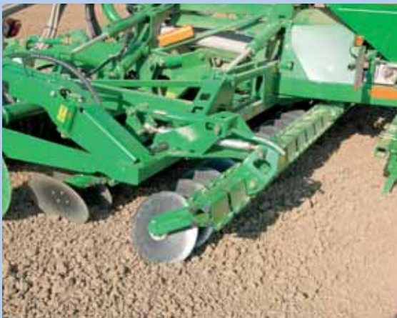
Die 460-mm-Scheiben sind flach angestellt. Sie ebnen gut ein, gerade über 10 km/h. Die Tiefenverstellung arbeitet hydraulisch.
