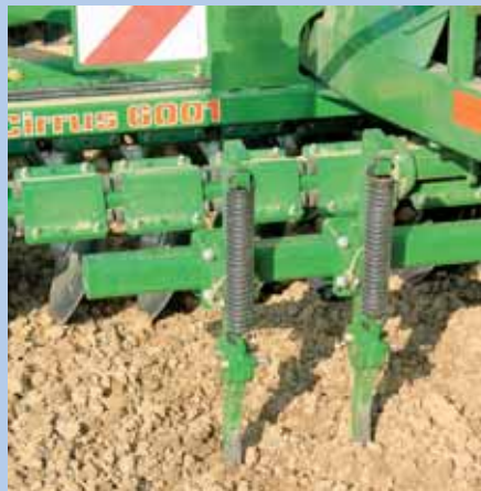
Höhenverstellbare Vierkantprofile mit 50 x 30 mm dienen als Spurlockerer. Wechselbare Scharspitzen gibt es keine.
