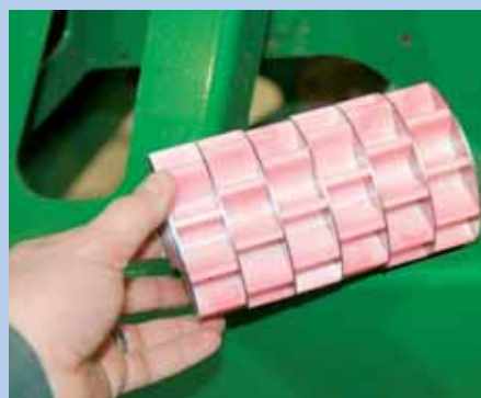
Drei verschiedene Dosierwalzen stehen zur Wahl für Saatmengen zwischen 2 und 400 kg/ha. Der Wechsel ist nicht schwer.
