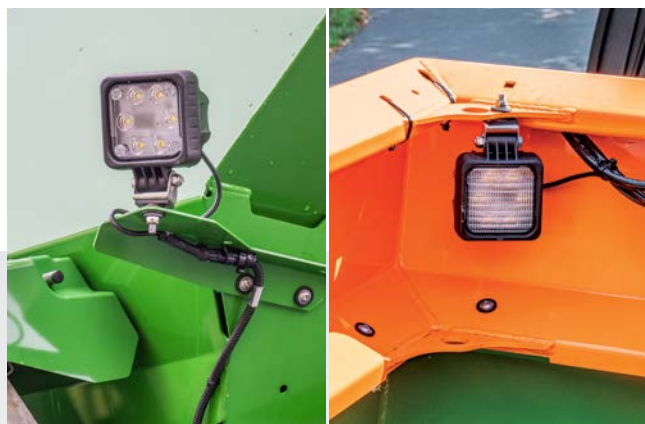
Oświetlenie robocze na zewnątrz i wewnątrz zbiornika
