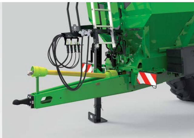
✓ Zaczep dolny ze sprzęgiem kulowym K80
