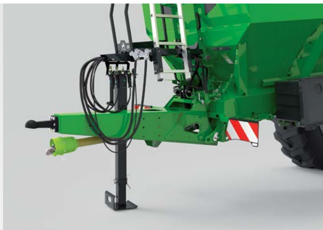
✓ Ucho zaczepu lub zawieszenie górne ze sprzęgiem kulowym K80
