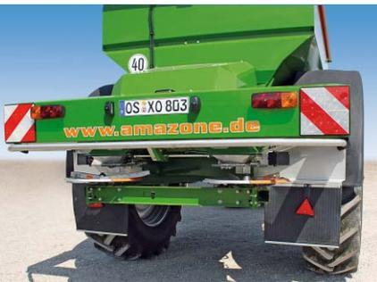
Den ZG-B gibt es mit einem Fassungsvermögen von 5.500 und 8.200 l. Die Arbeitsbreiten können unterschiedlich variiert werden. Auf Wunsch kann ein integriertes Wiegesystem eingebaut werden, mit dem die Streumenge kontinuierlich überprüft und nachreguliert werden kann.
