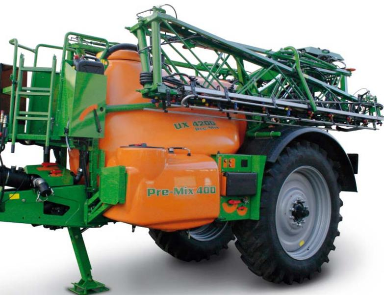
Mit Pre-Mix wird eine neue Qualität in der Pflanzenschutztechnik erreicht. Sie ermöglicht die Vormischung des Wirkstoffs (flüssig und / oder Granulate) in einem separaten Behälter und die Fertigmischung mit Klarwasser während der Ausbringung. So arbeiten die Düsen immer mit einem optimalen Tropfenspektrum und die Wirkstoffmenge kann hiervon unabhängig den pflanzenbaulichen Bedürfnissen angepasst werden.
