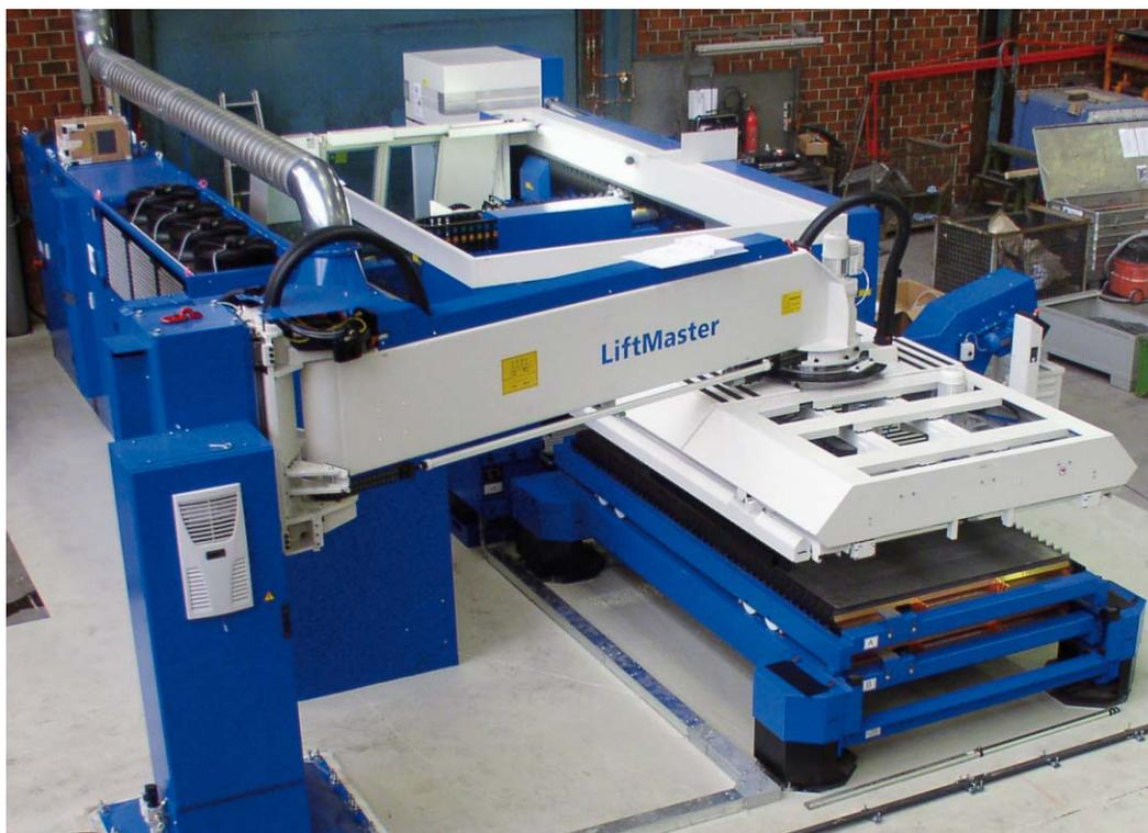
Besonders bei neuen Teilen, die häufig noch einmal geändert werden bevor sie in größere Serien gehen, ist das Auslasern die schnellere und einfachere Lösung. Die neu angeschaffte Lasermaschine kann sogar für längere Zeit ohne Bedienung laufen und der Mitarbeiter kann in dieser Zeit andere Arbeiten erledigen.
