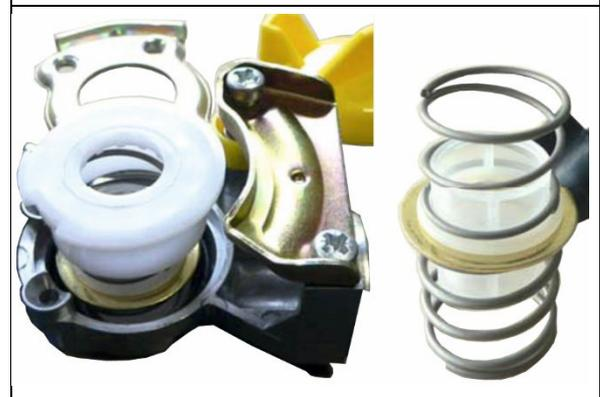
**!** O-Ring korrekt auf dem Kunststoffring positionieren.
