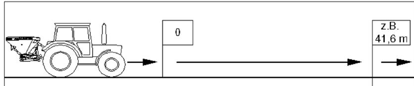
2. Messstrecke auf dem Feld exakt abmessen. Anfangs- und Endpunkt der Messstrecke markieren.
