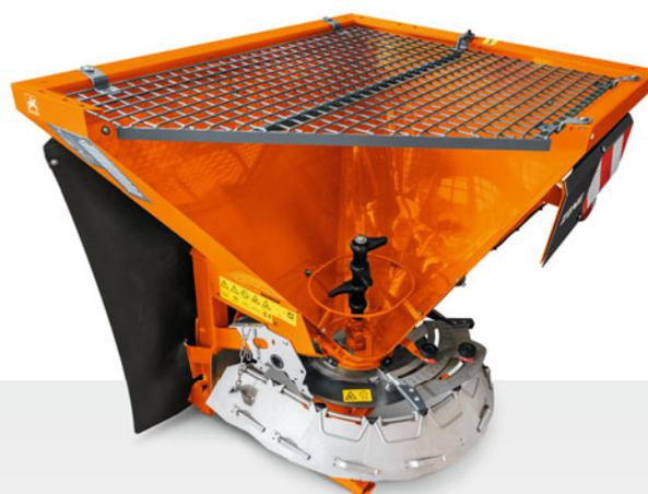
Uitsnedemodel van de driepuntsstrooier E+S met staafroerwerk voor zand en zout
