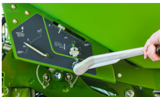
Centrale traploze mechanische verstelling van de kouterdruk met schaalverdeling bij de Cataya Super
