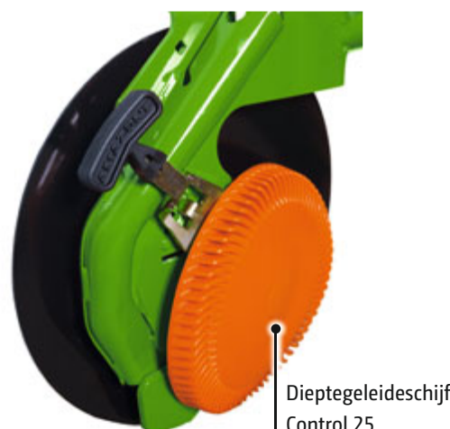
RoTeC-kouter (Ø 320 mm) met Control 25 dieptegeleidingsschijf De naar achteren openstaande lamellen zorgen voor een zeer goede zelfreiniging.
