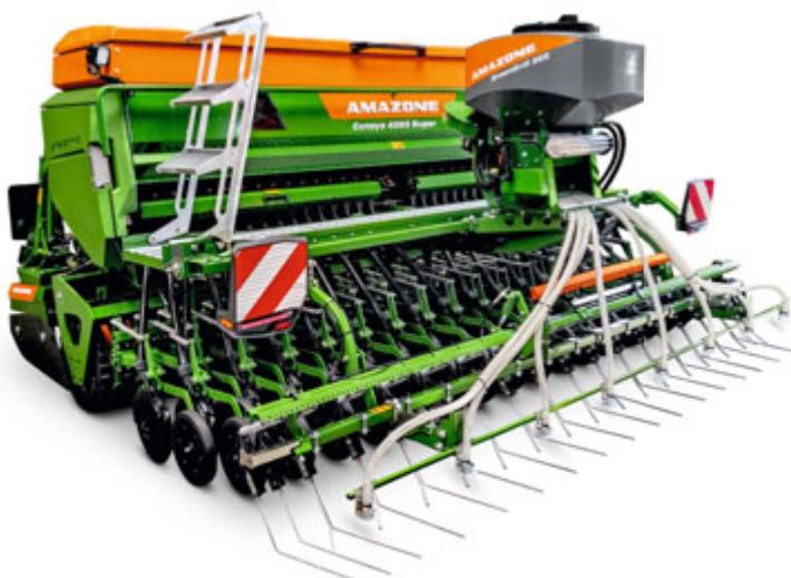
Cataya 4000 Super sa 4 m radnog zahvata, TwinTeC-dvostrukim diskosnim ulagačem sa perastom branom i 1.730 l zapremine rezervoara
