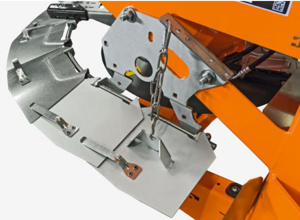
В базовой комплектации распределителем можно управлять и без компьютера управления. Ширина захвата адаптируется при этом механически с помощью щитка.
