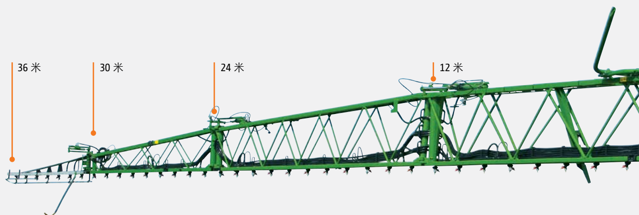
Super-L2 型喷杆宽 36 米，可折叠为 30 米、24 米和 12 米
