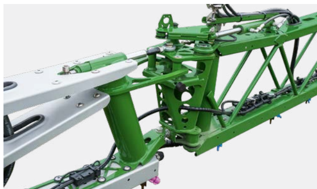
喷杆末端的液压加压回切系统（其工作原理与轿车门原理相同）可应对来自后方、前方或上方的障碍物，并确保可靠地返回工作位置并实现较长的使用寿命。
