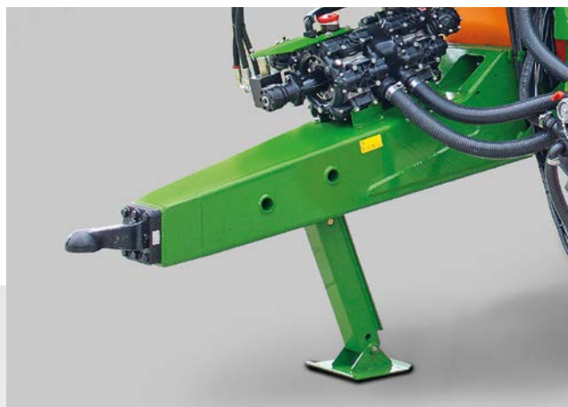
配有 K80 接合器和液压驻车千斤顶的下置式牵引杆
