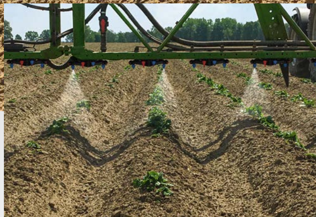
在马铃薯作物中进行特定行的带式喷洒
