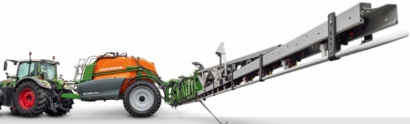
运输过程中喷杆的弹簧阻尼
