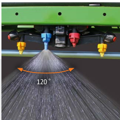
AmaSelect 电动独立喷嘴控制，四喷嘴体和 50 厘米和 25 cm 喷嘴间距
