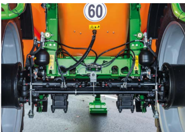
UX 4201 和 UX 5201 采用带 AutoTrail 轴转向的液压气动车轴悬挂系统
