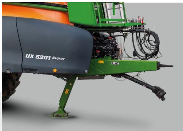
配有拉杆和液压驻车千斤顶的顶置式牵引杆
