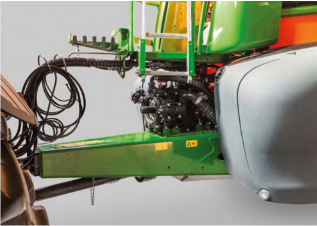
UX 4201 超级型、UX 5201 超级型和 UX 6201 超级型的串联双泵系统提供高达 700 升/分钟的吸入量
