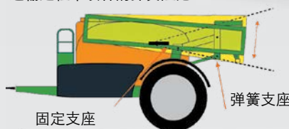
运输过程中喷杆的弹簧阻尼
