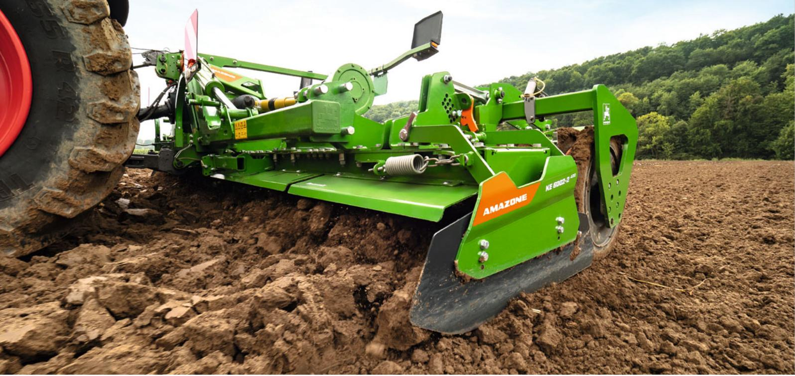
KE 6002-2-400 Rotamix, 400 hp'ye kadar olan traktörler için onaylanmıştır ve özellikle yüksek çıkışı ve çok iyi inceltmesi ile karakterize edilir.
