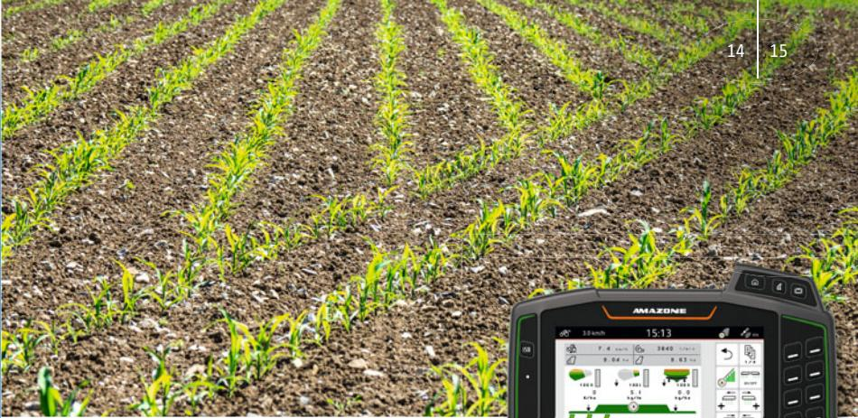
Con la licencia del software GPS Switch, AmaTron 4 permite el control individual de hileras tanto para semillas como para abono
