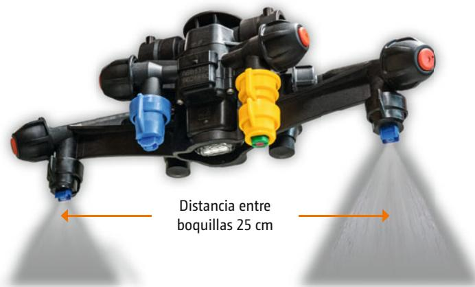
Además de la distancia entre boquillas de 50 cm, AmaSelect también permite una **distancia real entre boquillas de 25 cm**. En combinación con boquillas especiales de 80°, esto ofrece la ventaja de reducir la distancia de la superficie objetivo a menos de 50 cm y minimizar así la deriva durante la aplicación. El conductor puede alternar entre una separación de boquillas de 50 y 25 cm durante la aplicación.
