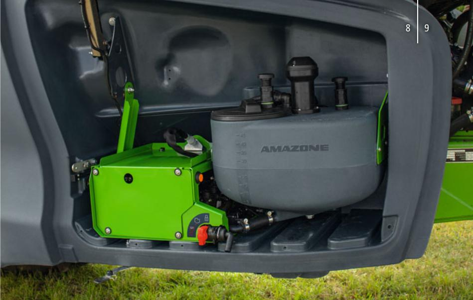
Equipamiento DirectInject con depósito de 50 l y unidad de bomba en el compartimento del UX 01 Super
