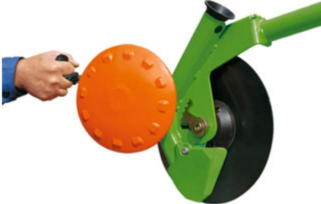
Control 10 derinlik kılavuz diskli RoTeC ekim ayağı( $\varnothing$  320 mm)
