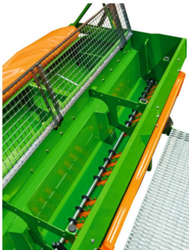
Sonradan takılabilen C-Drill gübre sistemi için gübre tankı, D9 Super'in tohum tankına harici olarak monte edilmiştir
