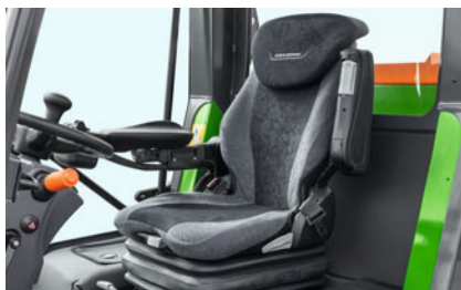
Verschillende stoelvarianten, bijv. de stoel "De Luxe" van Grammer met luchtvering en stoelverwarming
