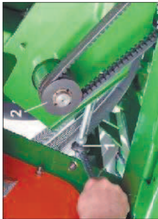
Antriebsriemen und deren Spannung sind zu überprüfen.
