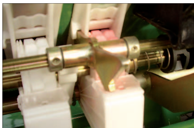
Die Axialsicherung der Vorgelegewelle muss im Sägehäuse unbedingt entsprechend verankert sein.
