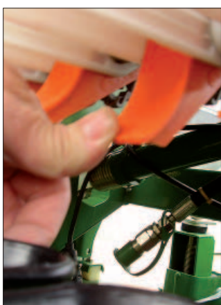
Leichtgängigkeit der Bodenklappen kontrollieren.
