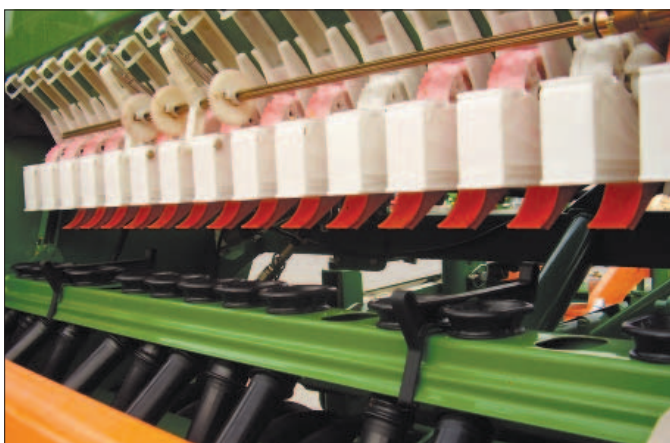
Bodenklappen dürfen nicht beschädigt sein.
