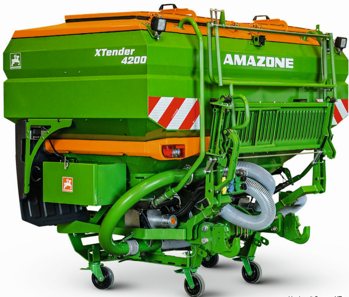
Навісний бункер XTender 4200 з об'ємом 4.200 л
