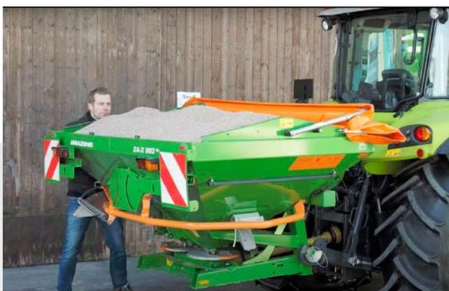
Après le remplissage, la bâche repliable est de nouveau fermée. L'épandage d'engrais peut ainsi se poursuivre, même en cas de mauvaises conditions météorologiques.
