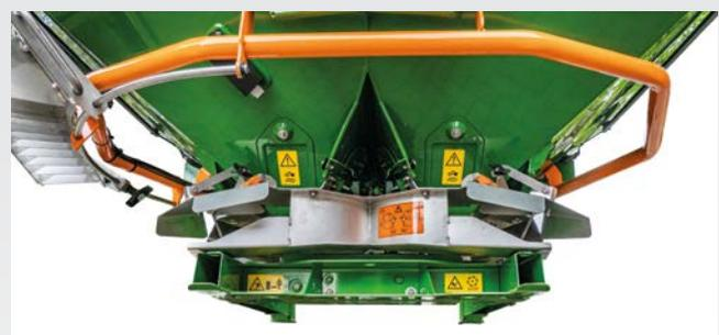
Répartiteur d'engrais juste derrière les disques d'épandage
