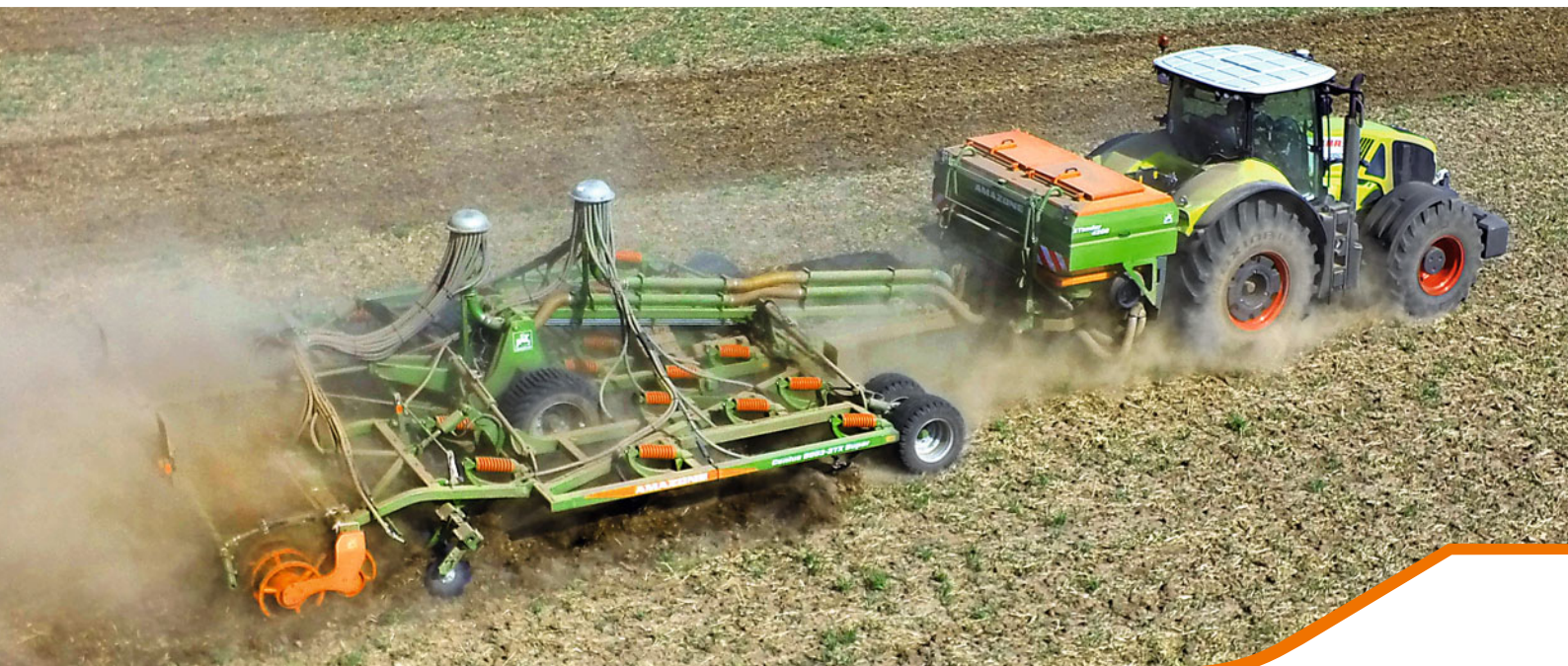
XTender 4200 med Cenius 6003-2TX og 2 transportstrækninger til udbringning af gødning og såsæd
