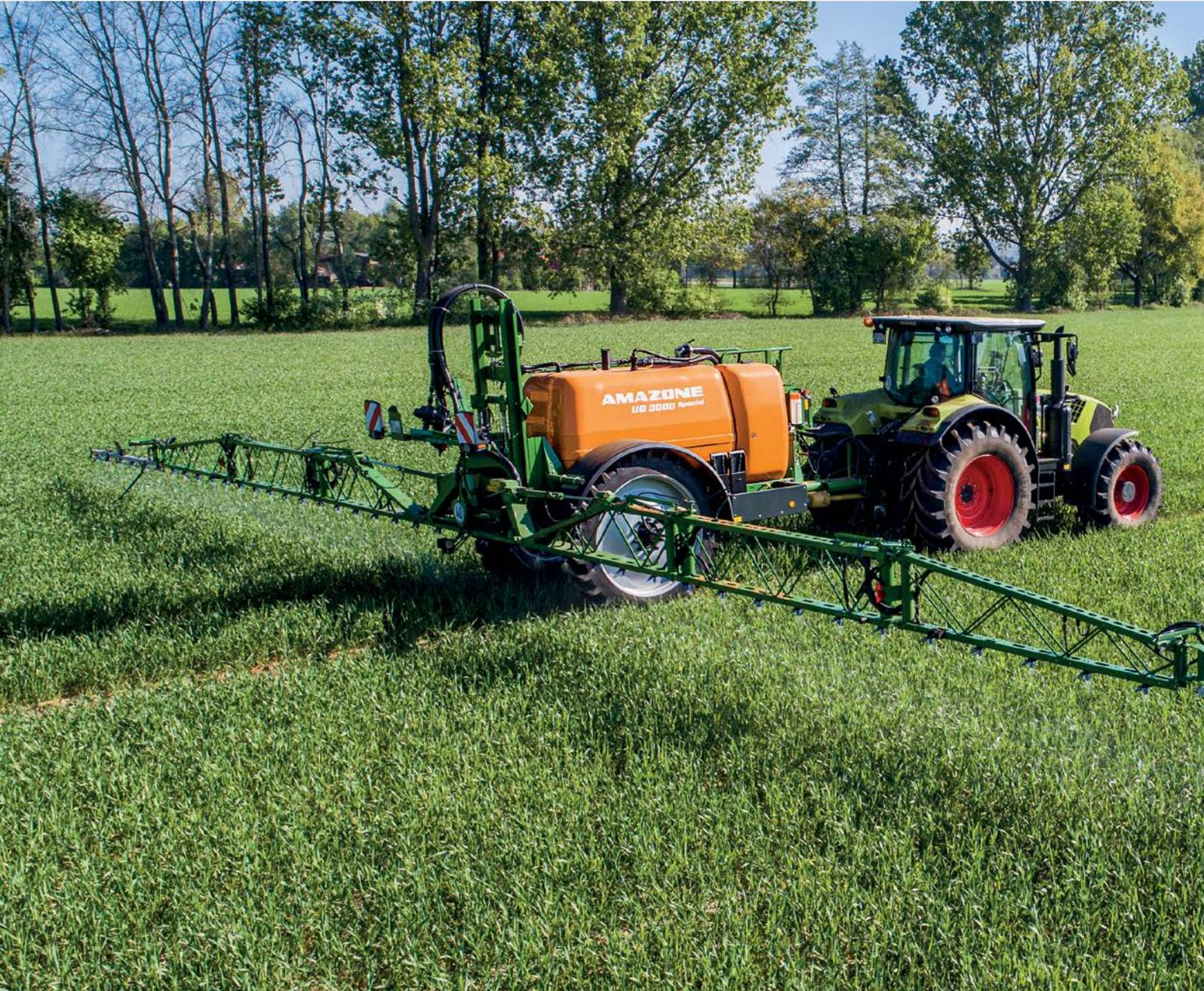
I polverizzatori trainati UG da 2200 e 3000 litri, sono caratterizzati da un design molto robusto e sono di semplice utilizzo. Con le barre Super S2 con larghezze di lavoro da 15 a 28 m, è una macchina particolarmente efficiente.
