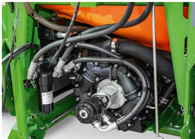
Azionamento idraulico della pompa per la pompa da 300 l/min dell'UF 02
