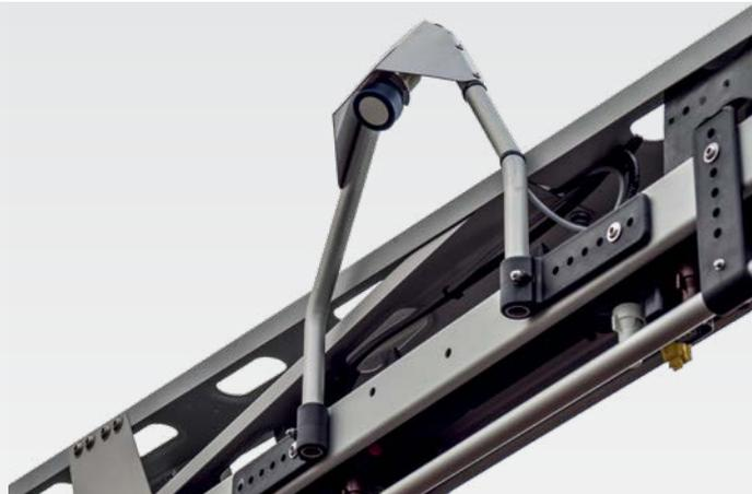
I sensori rilevano con precisione la distanza di riferimento in altezza e si occupano dell'operazione
