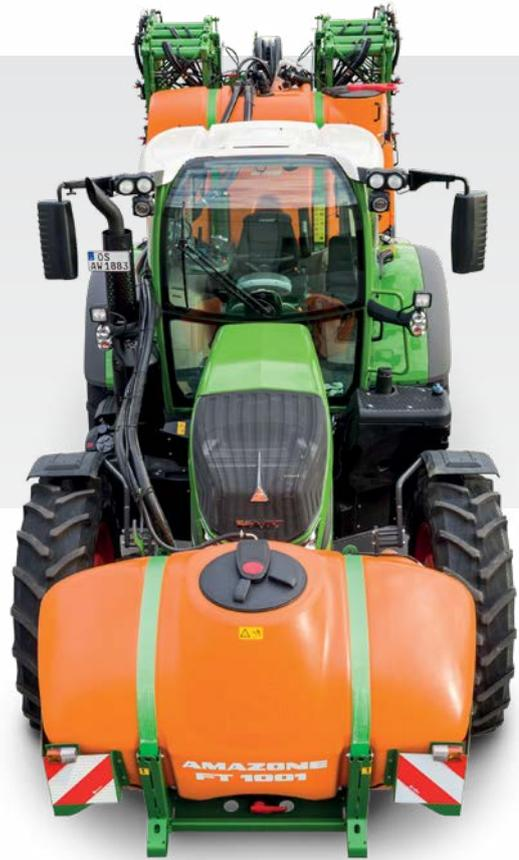
L'impianto di illuminazione opzionale è necessario nei casi in cui le luci del trattore vengono nascoste. Le luci anabbaglianti nascoste del trattore vanno in tal caso riportate sul tetto. Il montaggio sul serbatoio frontale non è consentito.
