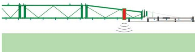
DistanceControl se dotato di due sensori: misurazione della coltura
