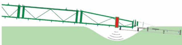
DistanceControl quando è dotato di due sensori: la barra può immergersi nella coltura, ad esempio in presenza di cereale allettato
