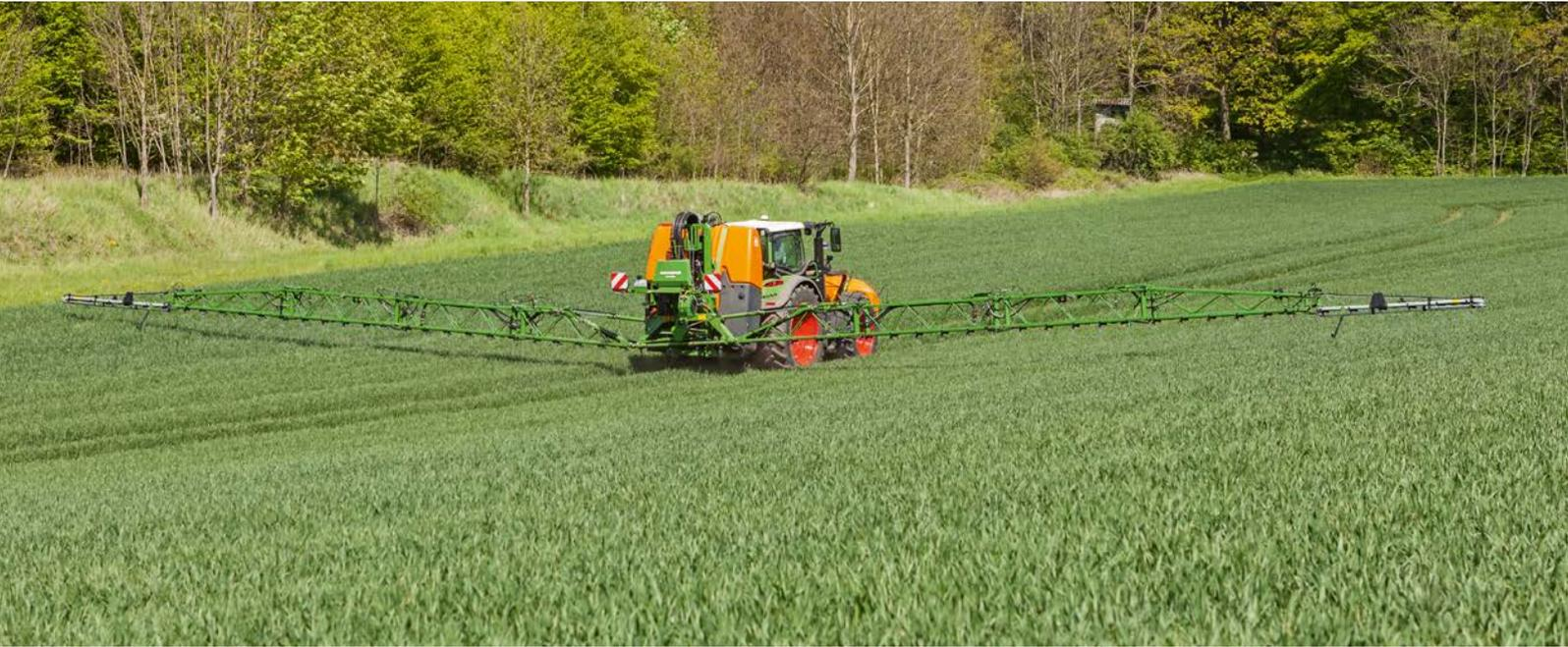
Il polverizzatore portato UF 2002 è dotato di ContourControl per la guida completamente automatica della barra
