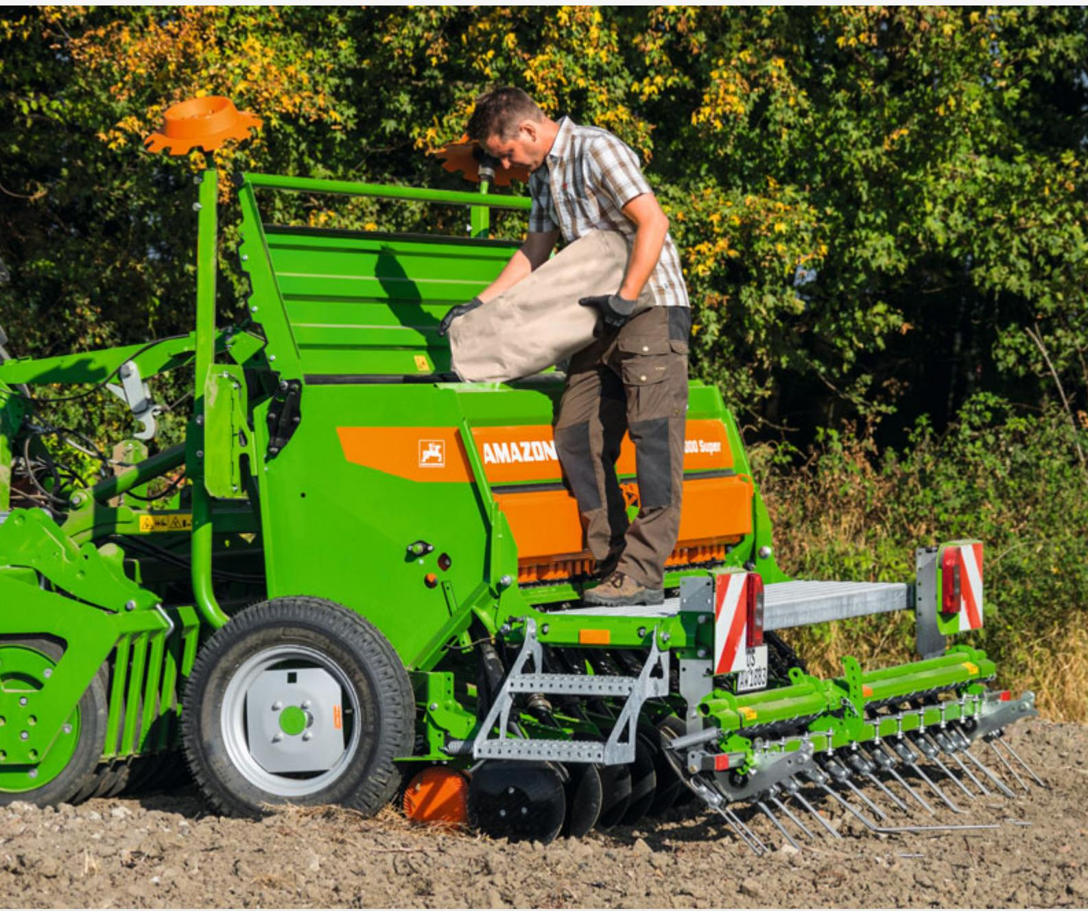
Den sikre opstigning via de klapbare trin og læssebroen giver nem adgang til såsædsbeholderen.
