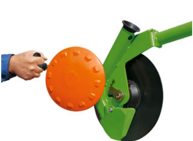
RoTeC-skær ( $\varnothing$  320 mm) med dybdeføringstellerken Control 10
