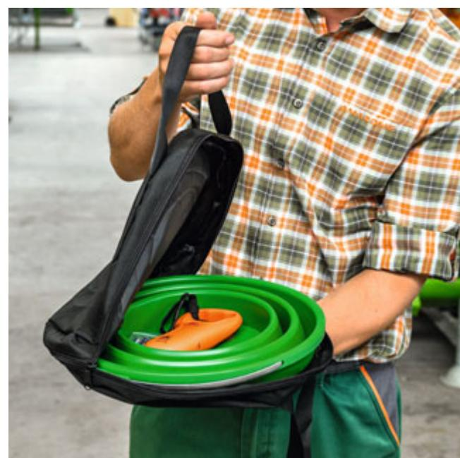
Det som standard medfølgende kalibreringssæt med foldespand og hængevægt er kompakt og praktisk at transportere
