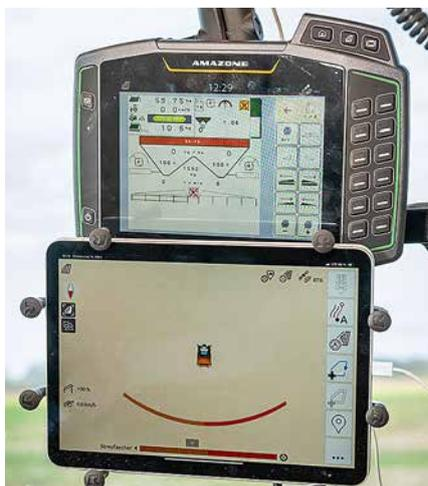
Mit Amatron4 und einem iPad klappt die Bedienung und Überwachung optimal.
