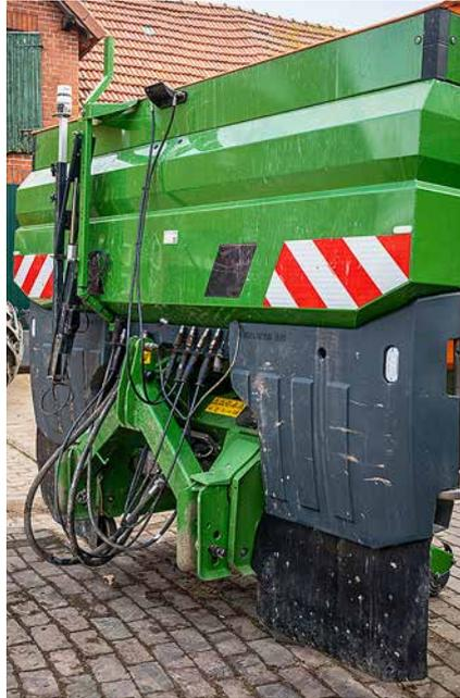
Der Anbauraum ist aufgeräumt. Das WindControl-Instrument ist hier abgesenkt.
