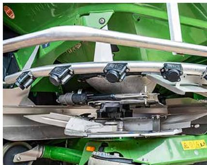
Die ArgusTwin-Radarsensoren überwachen den Streufächer zuverlässig.
