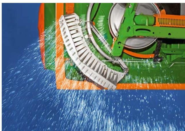
Устройство Limiter на прочной раме можно перемещать в пределах широкого диапазона перестановки. При этом Limiter устанавливается в нужное положение для распределения по краю, границе или вдоль канав в зависимости от сорта удобрений. Точные данные для этого приводятся в таблице распределения и на наклейке на агрегате.
