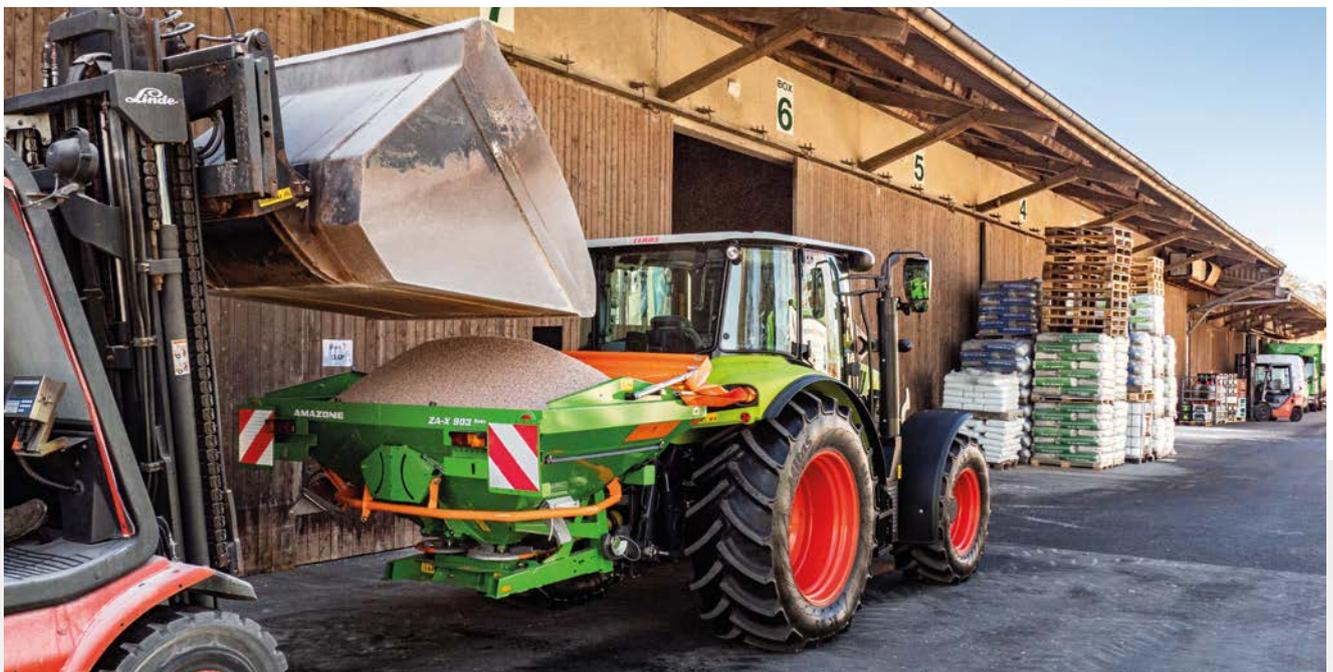
Auch ohne breiten Aufsatz ist die Befüllung mit einer Industrieladeschaufel möglich
