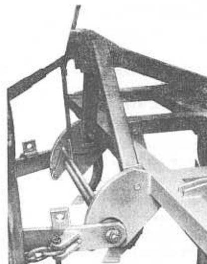
Abb. 14 Anbau B 365 C am Traktor mittels Tragachse
