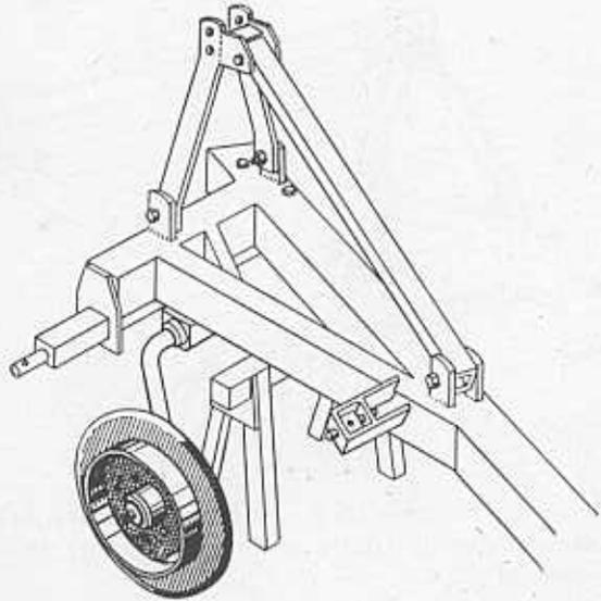
Abb. 10 Verbinden der Stützradfelge (11) mit der Radnabe (10) durch 5 Schrauben
