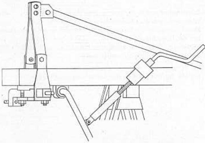
Abb. 11 Einführen der Spindel (14) in die Spindelführung am Rahmen, Spindel und Kurbel durch Kegelkerbstift verbinden. Einschrauben des Verstellstückes (13) in die Spindel. Befestigen des Verstellstückes (13) mit der Stützradachse (10) durch Halbrundniet und Splint.
