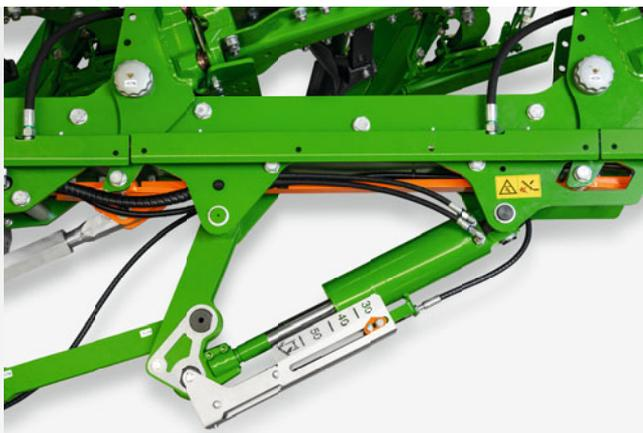
Hydraulische Einstellung der Arbeitsbreite
