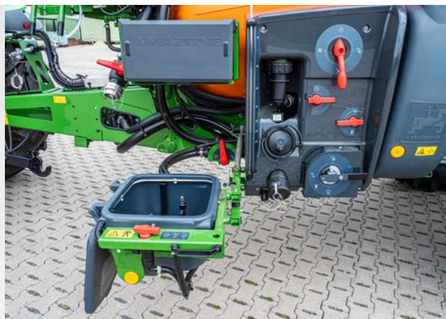
SmartCenter på maskinens venstre side med udkfoldet kemikaliepåfyldningsbeholder
