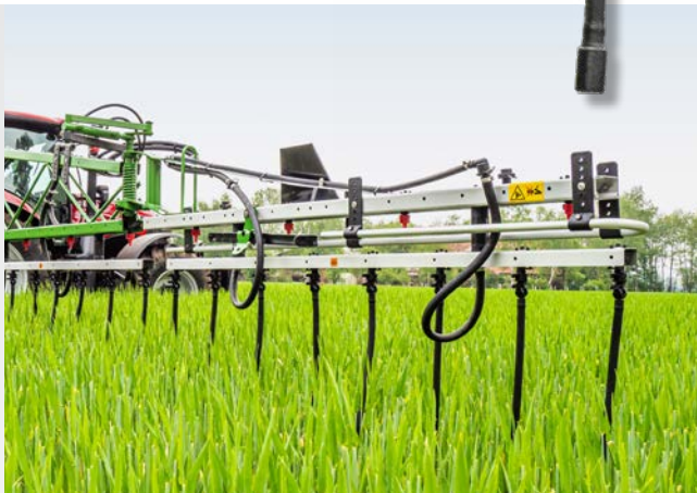
Slæbeslangekombination på Super-S2-bom
