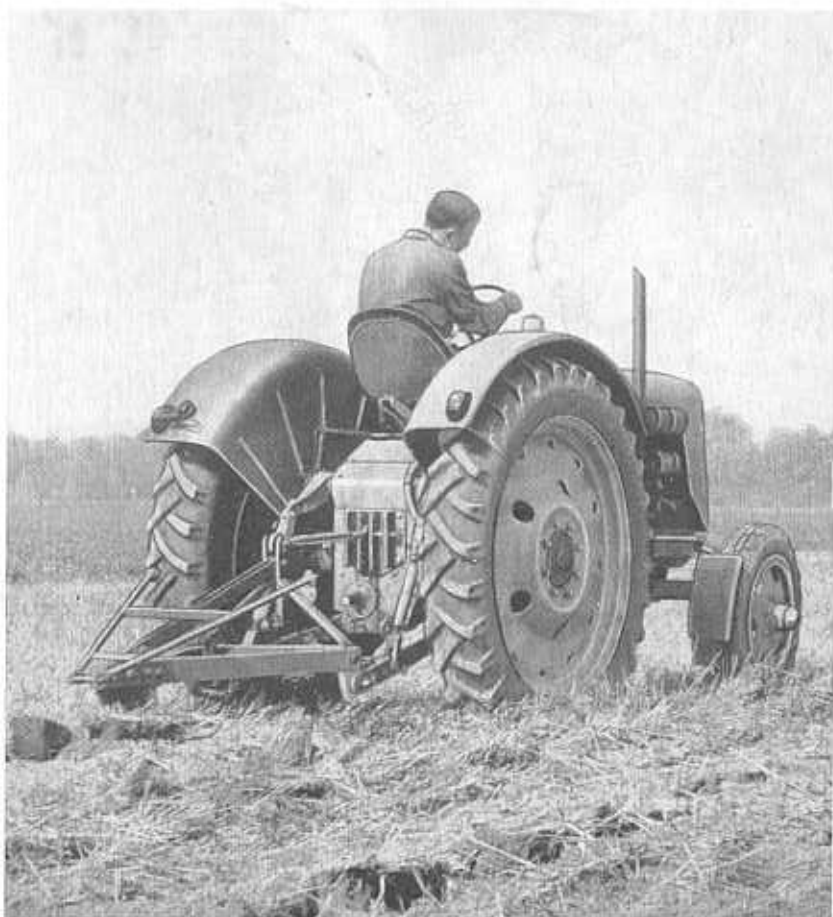
Abb. 10: Arbeitsbild eines Anbautieflockers
