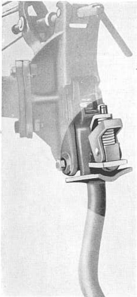
Abb. 16. Verriegelung des Hinterrades außer Eingriff
