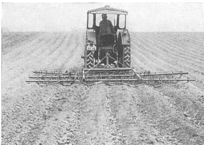
Abb. 6 Abschleppen von Kartoffeldämmen mit gewendeter Netzegge
