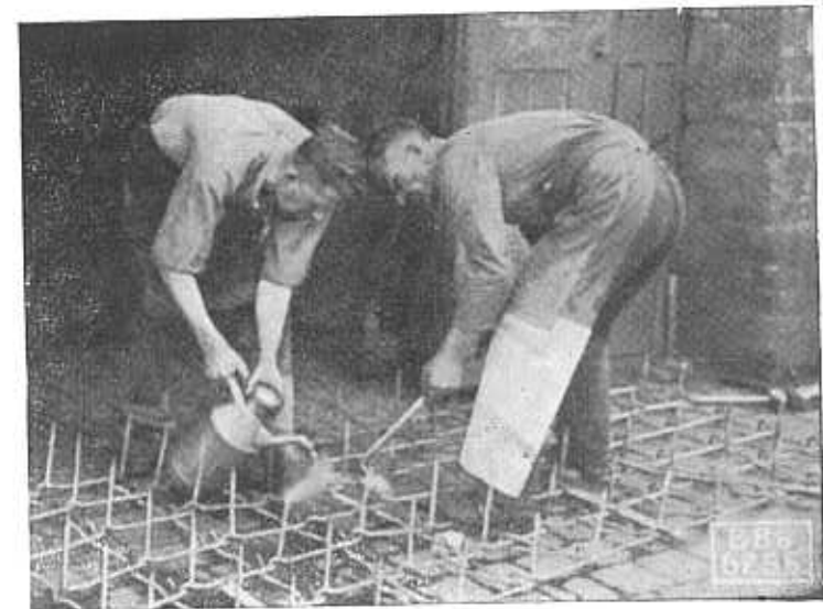
Abb. 9 Härten der Zinken durch Begießen mit der Gießkanne
