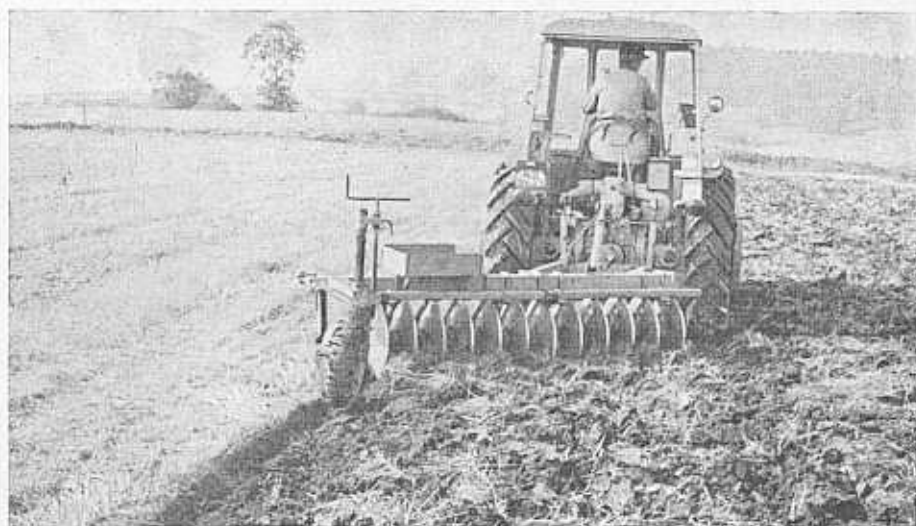
Aufsattel-Vielscheiben-Schälplug B 151 im Einsatz
