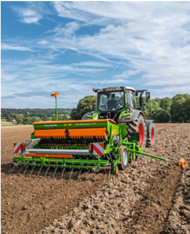
Gleichzeitiges Ausbringen von Saatgut und Dünger mit dem Düngersystem C-Drill spart Überfahrten und kann Erträge steigern
