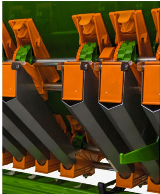
Der Dünger wird nach der Dosierung über Stutzen in die Auslässe der Saatgutdosierung geführt
