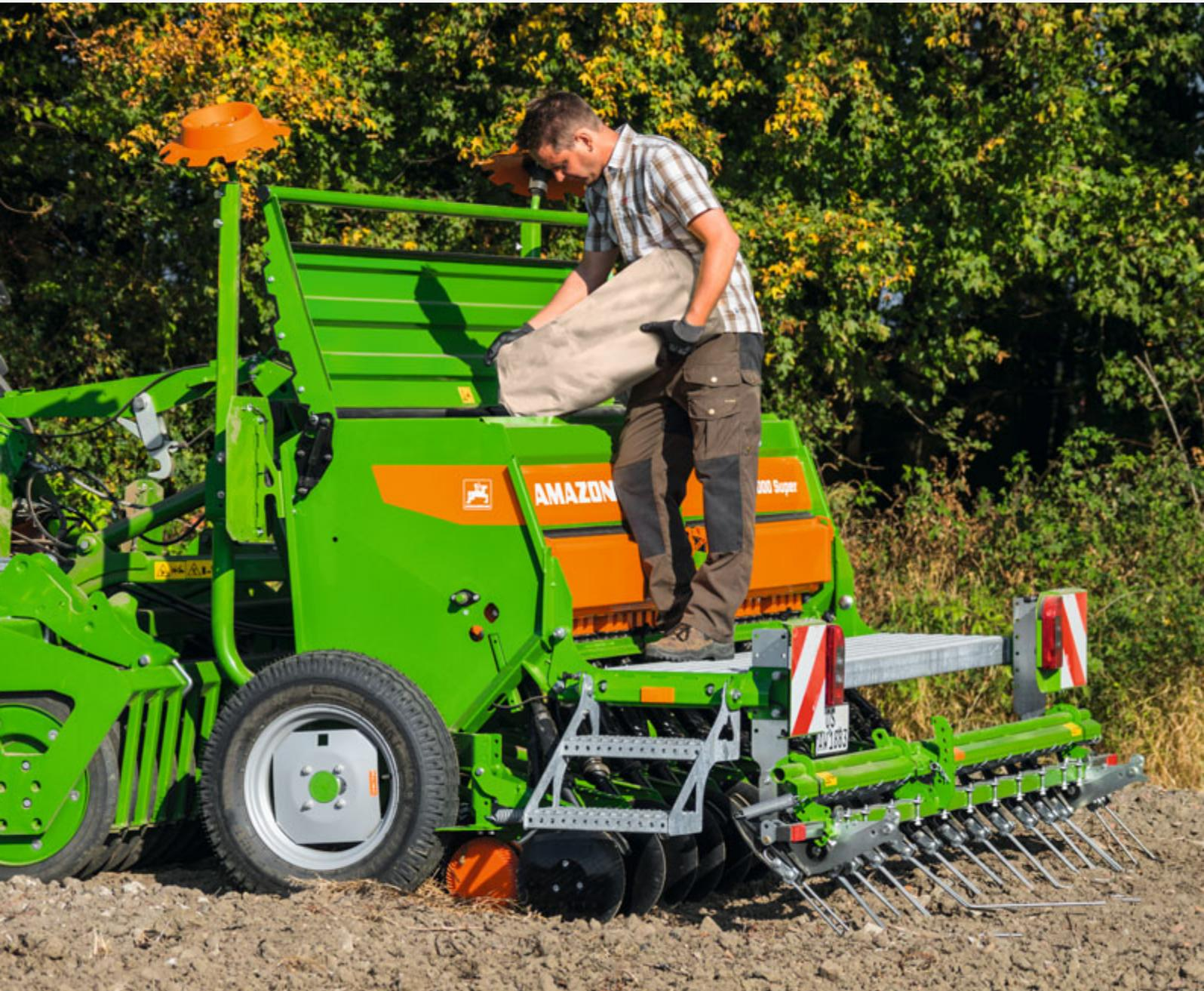
Der sichere Aufstieg über die klappbaren Trittstufen und den Ladesteg ermöglicht einen leichten Zugang zum Saatgutbehälter.
