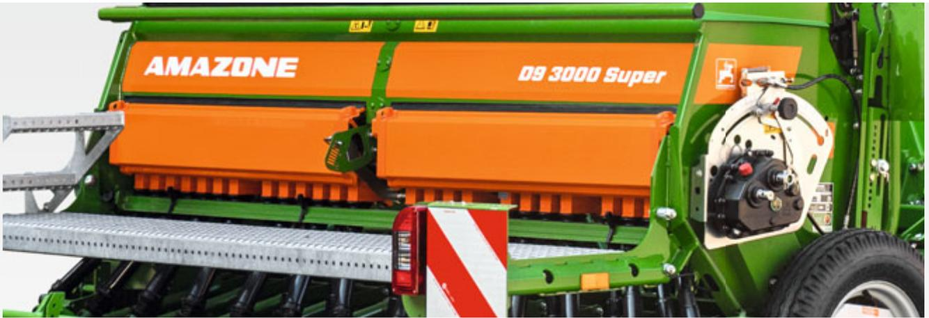
Saatgutbehälter der D9 mit stufenlos einstellbarem Vario-Getriebe
