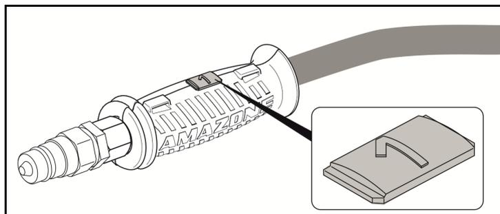
Para a marcação estão coladas películas na máquina que clarificam a correspondente função hidráulica.
