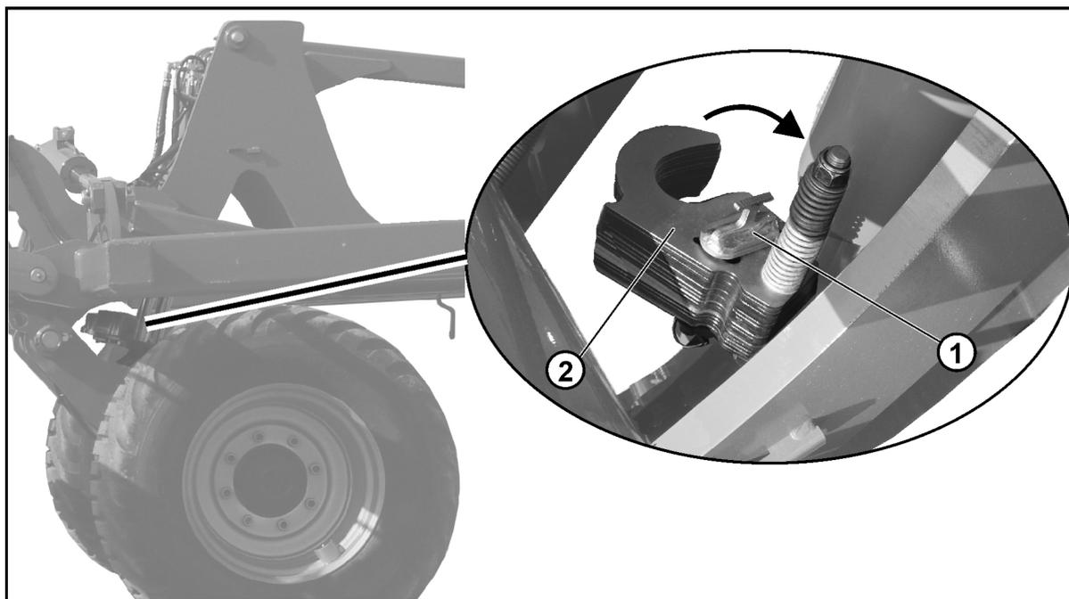
**Fixar/remover os elementos distanciadores no cilindro do chassis.**
