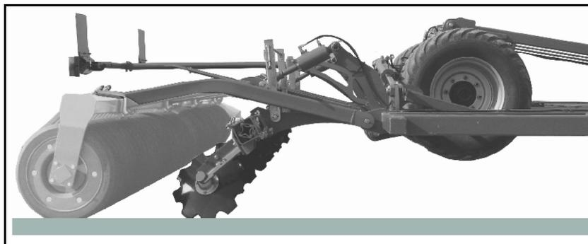
Chassis levantado em posição de utilização sem rolo
