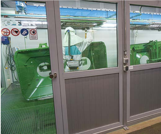
Salarié à l'installation de revêtement par poudre.
