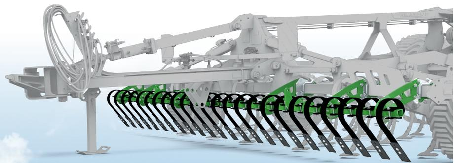
Crushboard mit hydraulischer Arbeitstiefenverstellung
