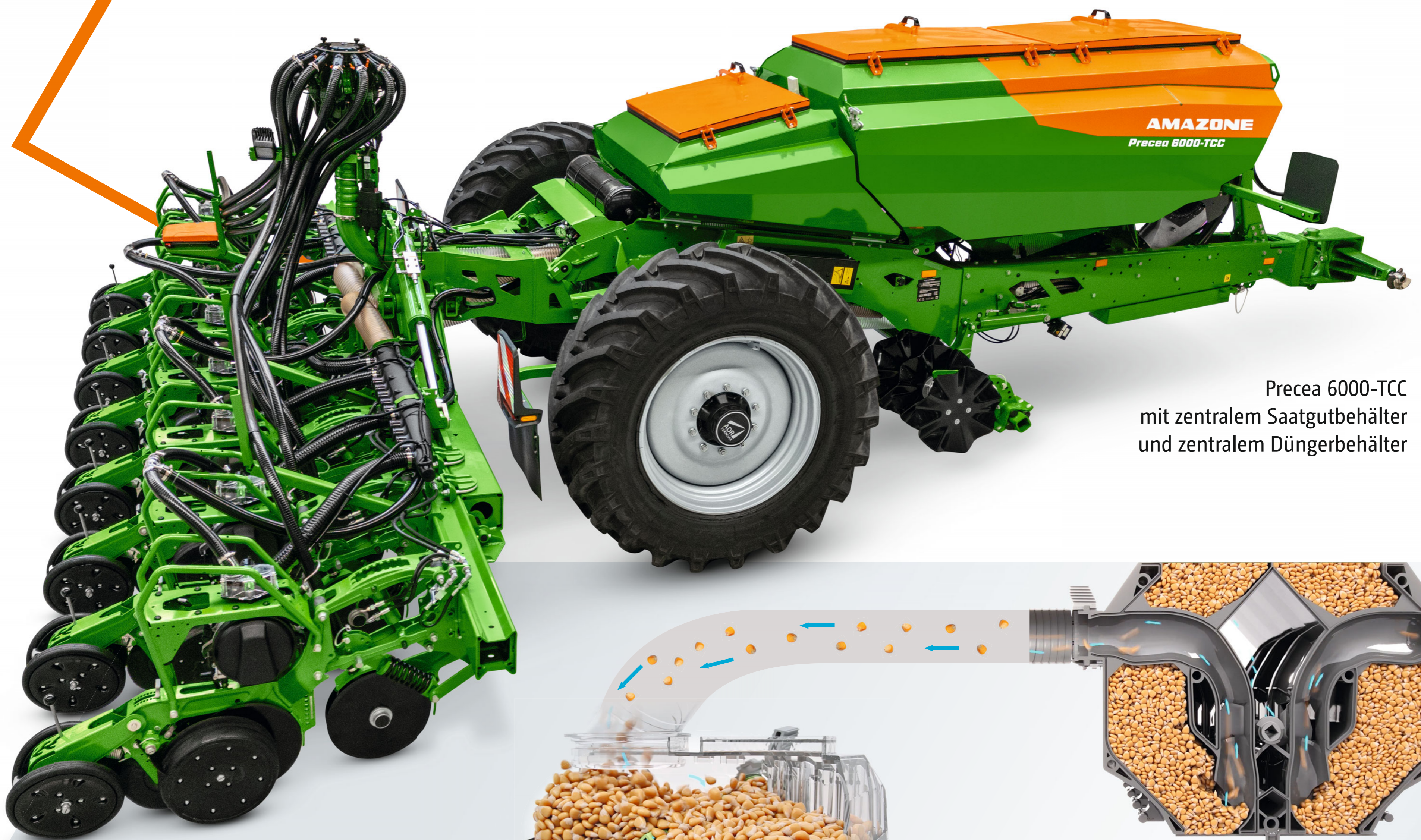
Darstellung Nehmer- einheit mit gefüllter Saatgutkammer
