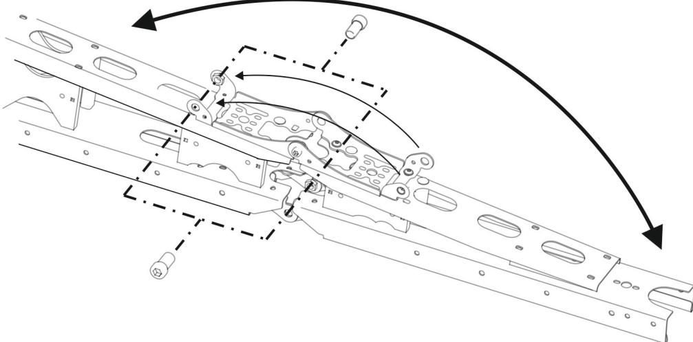
2 винта подсигуряват сгънатия и разгънатия външен елемент в крайните положения.
