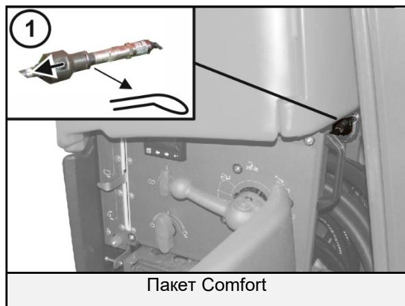
24. Отводнете устройството за измиване на ръцете и оставете крана отворен.
