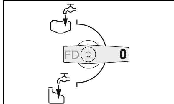
• Спирателен кран за изпразване на резервоара за течност за пръскане (EW)
