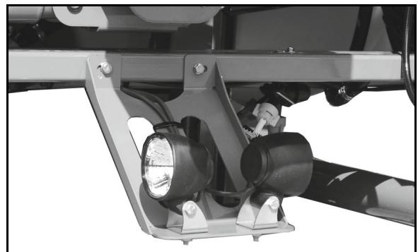
Светодиодное освещение отдельных форсунок:
