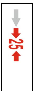
4-ной корпус форсунок может оснащаться держателем форсунок 25 см. При этом достигается расстояние между форсунками 25 см.
