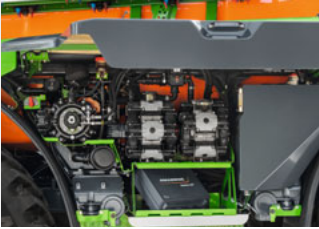
Unidad de bomba de fácil acceso y compartimento de almacenamiento adicional
