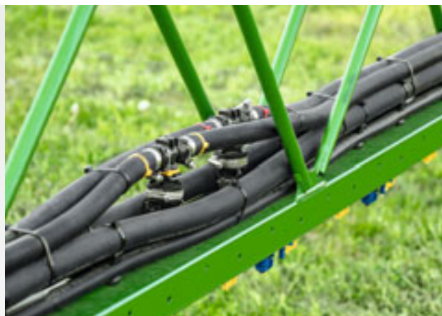
Puntos de alimentación de los 2 conductos de pulverización en el circuito circular
