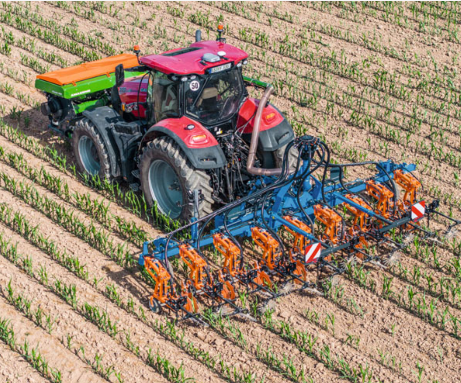
Binadora SCHMOTZER Venterra 2K en combinación con el tanque de montaje frontal AMAZONE FTender 1600 para el control de las malezas y la fertilización en una sola pasada.
