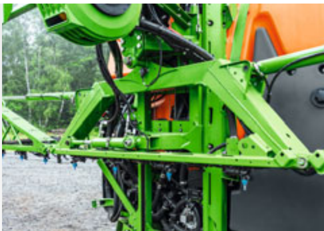
Guiado activo totalmente automático de la barra ContourControl
