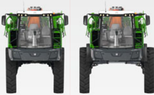
Variantes de tren de rodaje con ajuste hidráulico del ancho de vía
