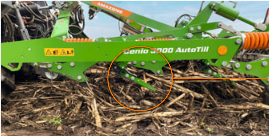
Detección integrada de obstrucciones en el segmento de púas
