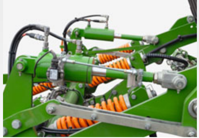
Sistema de medición de recorrido para ajustar la profundidad de trabajo sobre el rodillo de arrastre
