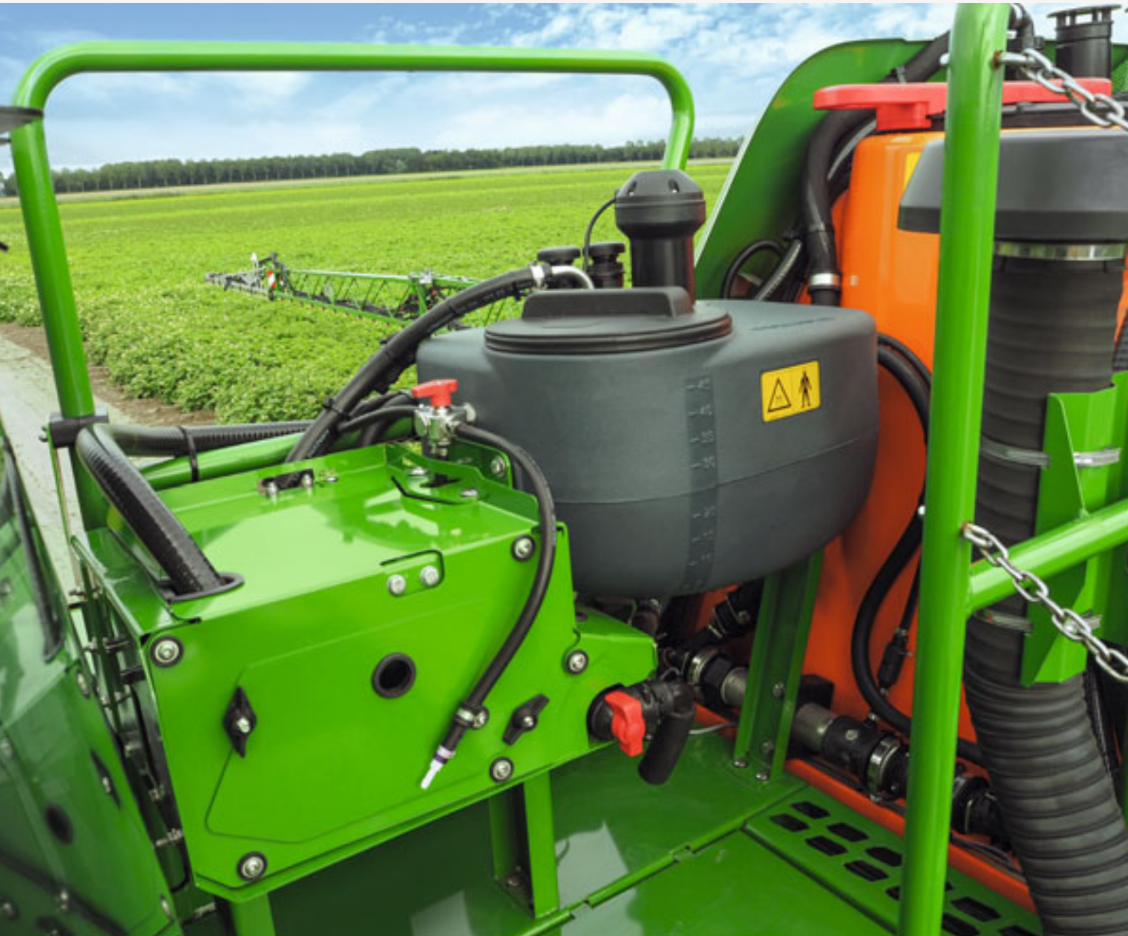
DirectInject en el Pantera 4504 entre la cabina y el tanque del líquido de pulverización
