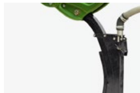
Стойка для внесения удобрений C-Mix 40 для Cenius-2TX: С помощью задвижки на стойках можно настроить глубину, на которую нужно внести удобрения.
