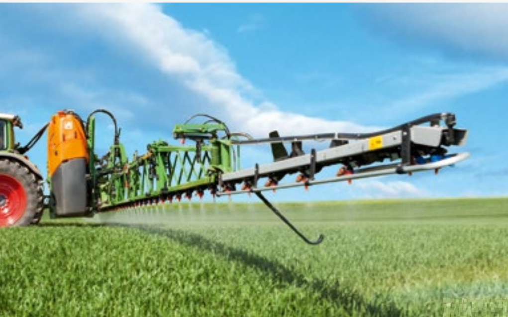
Навесной опрыскиватель UF 2002 со штангой Super-S2 30 м
