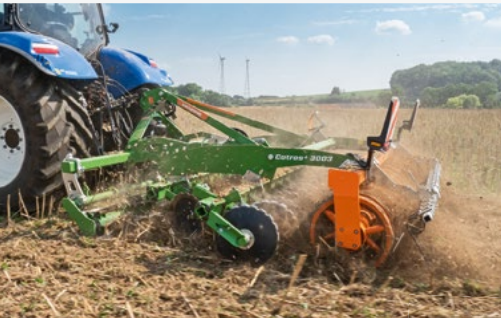
Catros + 3003 с вырезными дисками с шириной захвата 3 м
