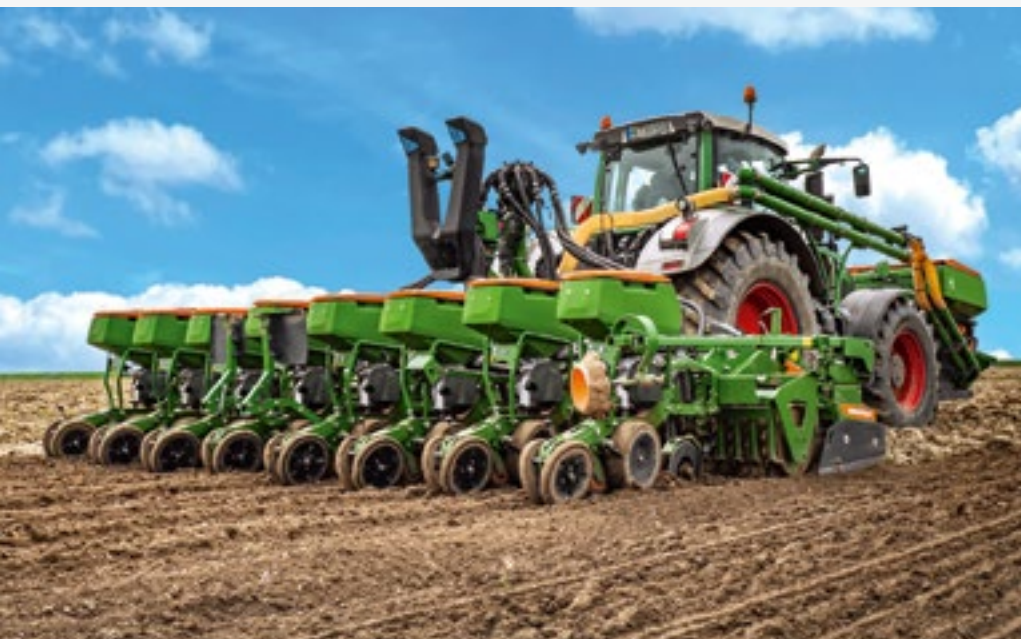
Сеялка точного высева Precea 6000-2AFCC с ротационным культиватором 6002-2 Super
