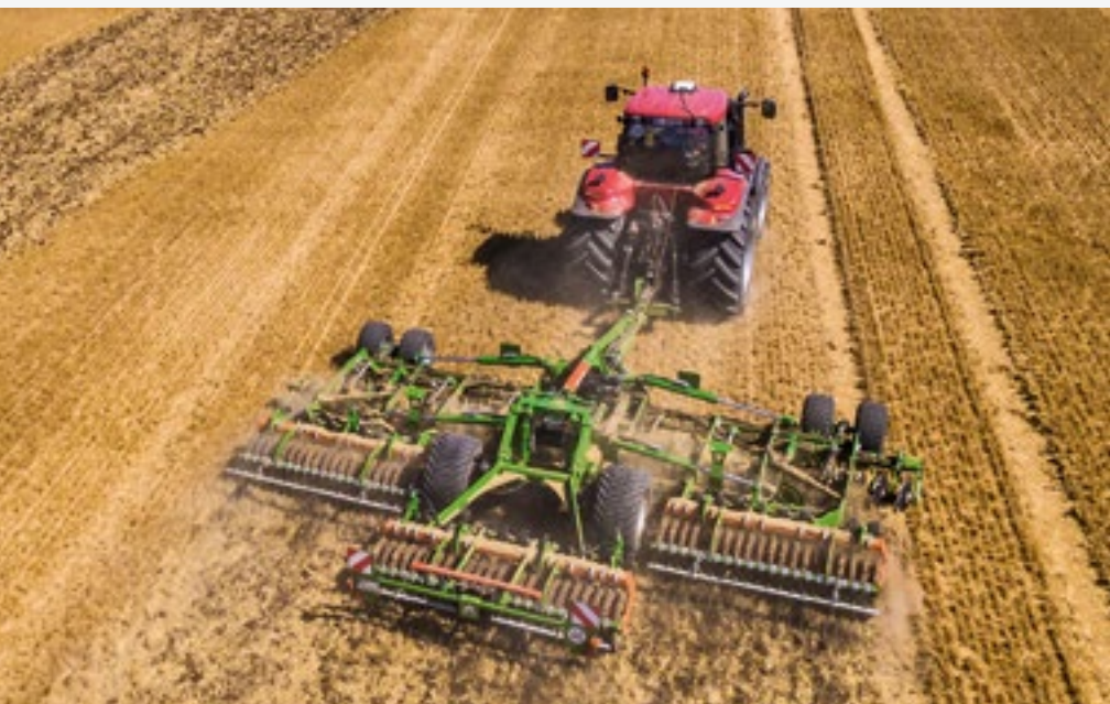
Catros + 8003-2TX с резино-клиновым катком с шинами Matrix с шириной захвата 8 м
