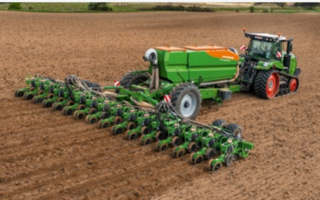
Precea 12000-TCC с шириной захвата 12 м и 16 рядами
