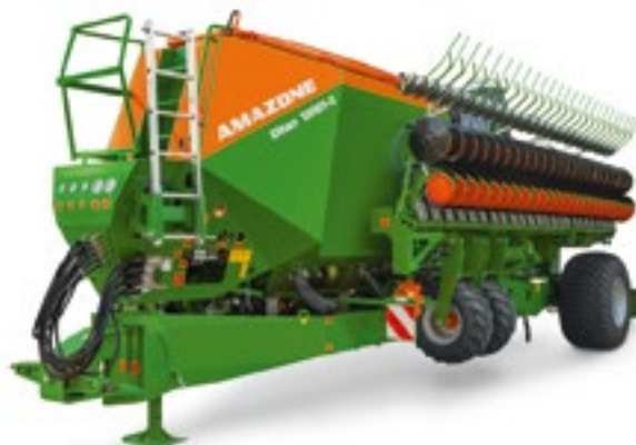
Citan 12000-C в сложенном состоянии с транспортной шириной 3 м
