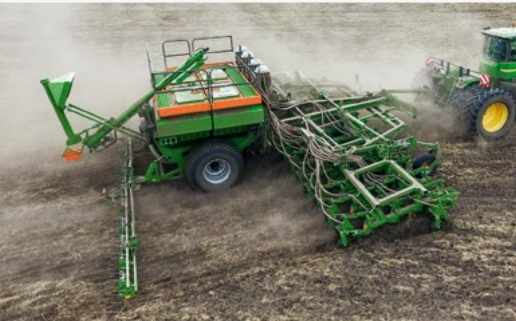
Primera DMC 12001-2C с шириной захвата 12 м с расположенными снаружи распределительными головками
