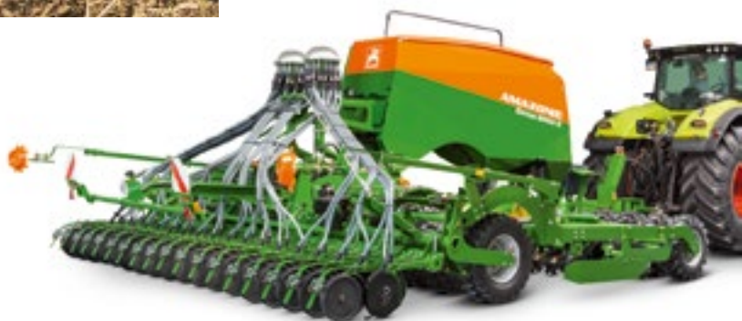
Посевная комбинация Cirrus 6003-2 с двухдисковыми сошниками TwinTeC +
