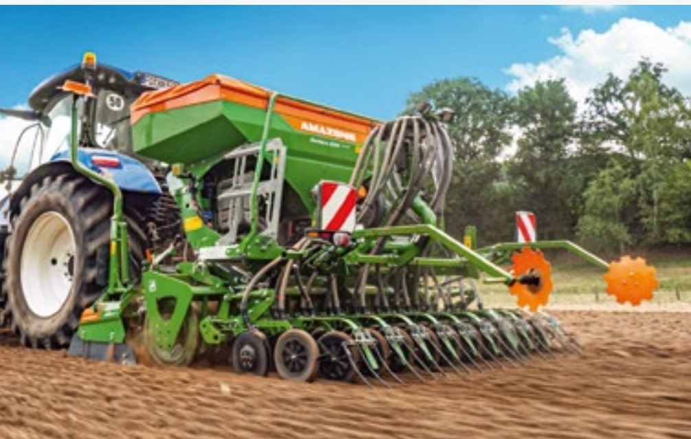
Centaya 3000 Special с двухдисковыми сошниками TwinTeC Special
