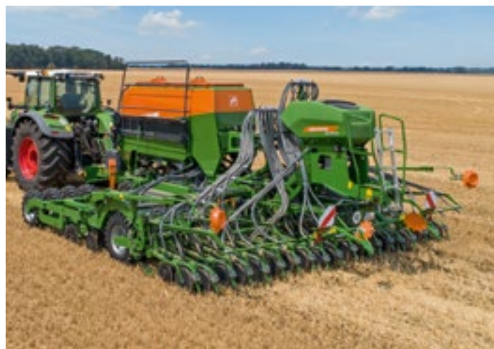
Cirrus 6003-2CC с дисками Minimum TillDisc – минимальная и влагосберегающая обработка почвы
