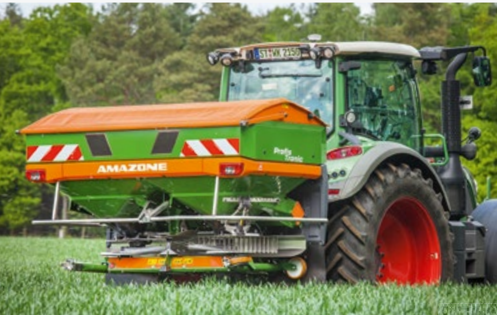
Распределитель со взвешивающим устройством ZA-V 2000 Profis Tronic с приспособлением Limiter V +
