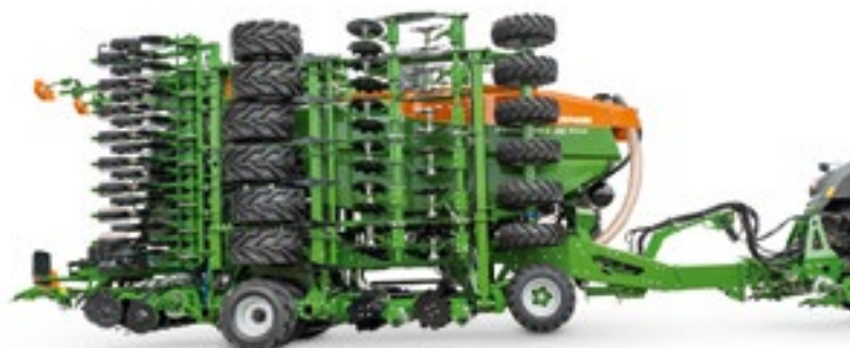
Cirrus 9004-2C Grand в сложенном состоянии с транспортной шириной 3 м
