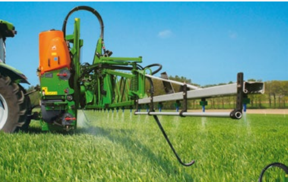
Навесной опрыскиватель UF 1201 со штангой Super-S2 18 м
