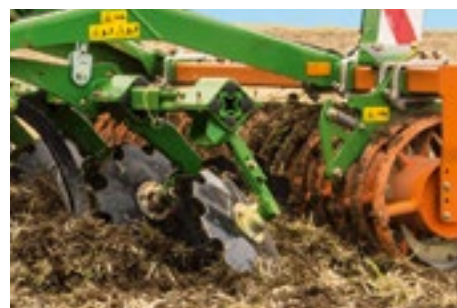
Вырезные выравнивающие диски 460 мм для работы даже при большом количестве соломы. Более выраженный эффект смешивания, чем при гладких дисках, надежный привод в любое время.
