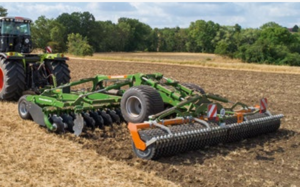
Certos 6002-2TX с шириной захвата 6 м с транспортным шасси TX
