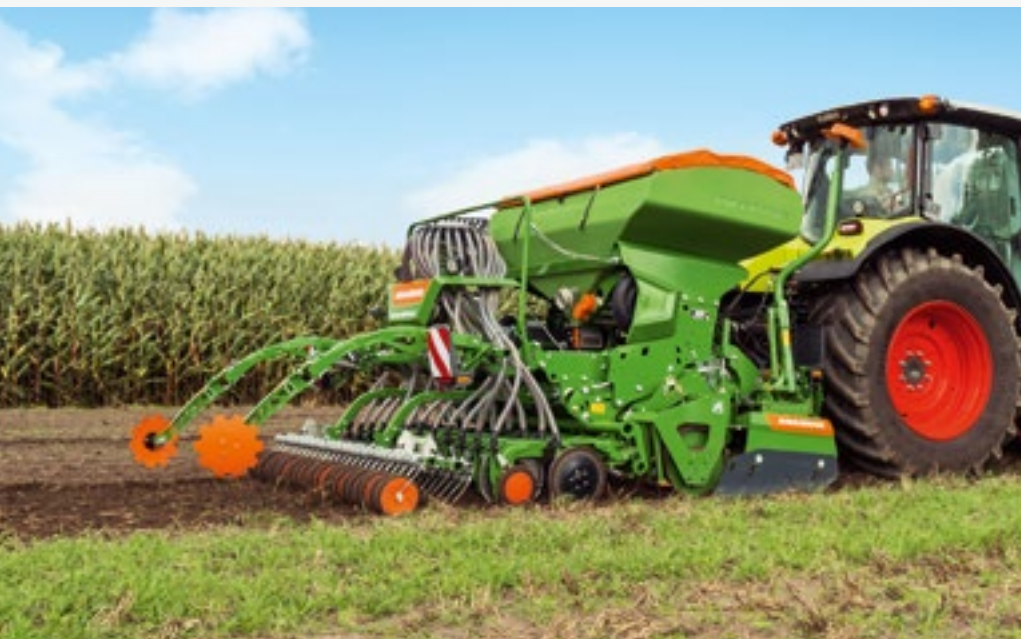
Centaya 3000 Super с однодисковыми сошниками RoTeC pro
