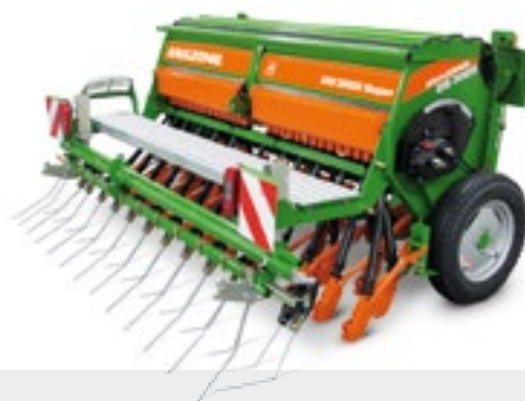
D9 3000 Super с шириной захвата 3 м и стандартным сошником WS
