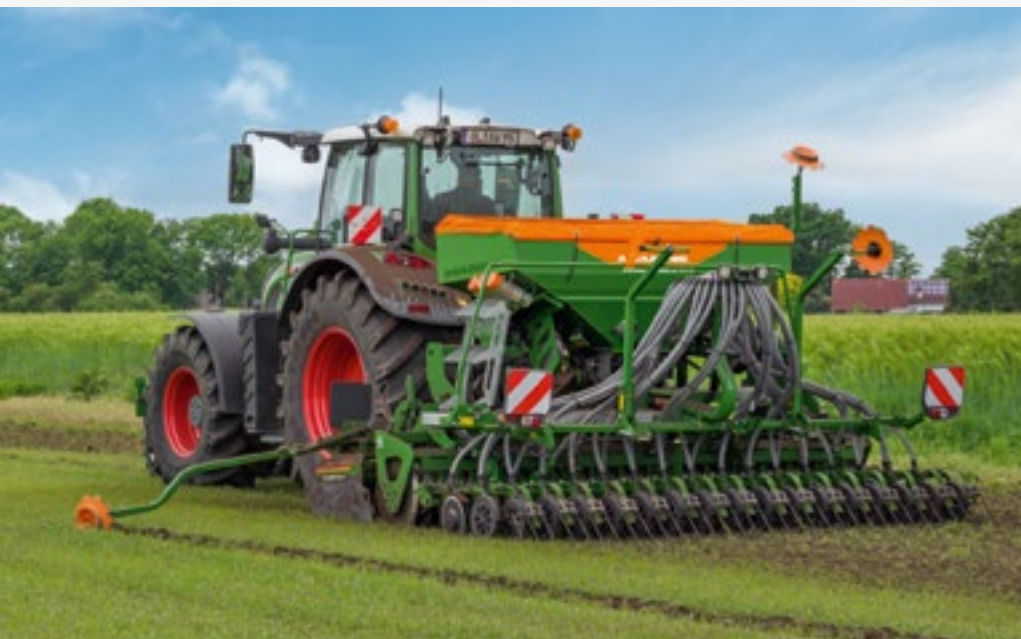
Centaya 4000-C Special с двухсекционным бункером
