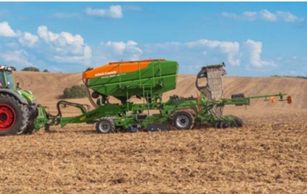
Cirrus 9004-2C Grand с шинами Matrix для полосового обратного уплотнения.
