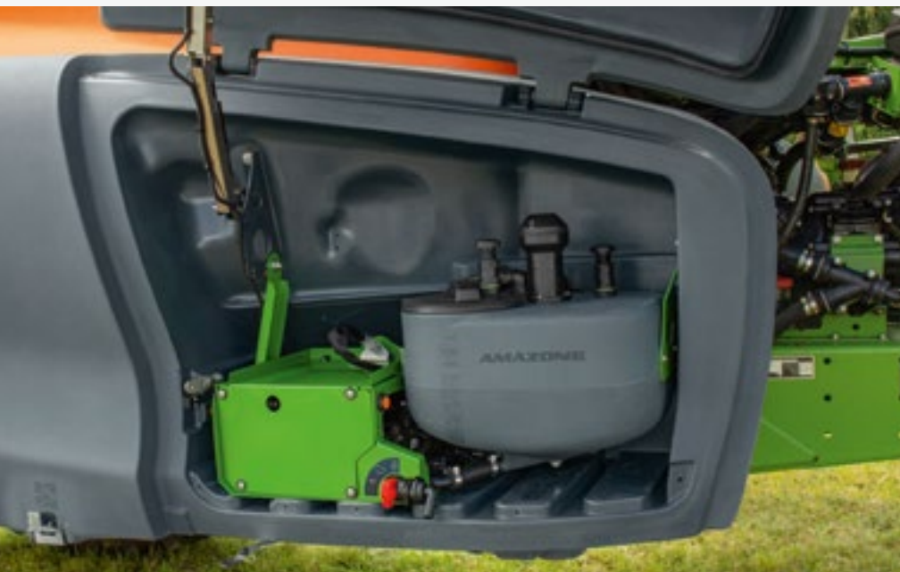
Оснащение DirectInject с баком 50 л и насосом в боксе для хранения UX 01 Super
