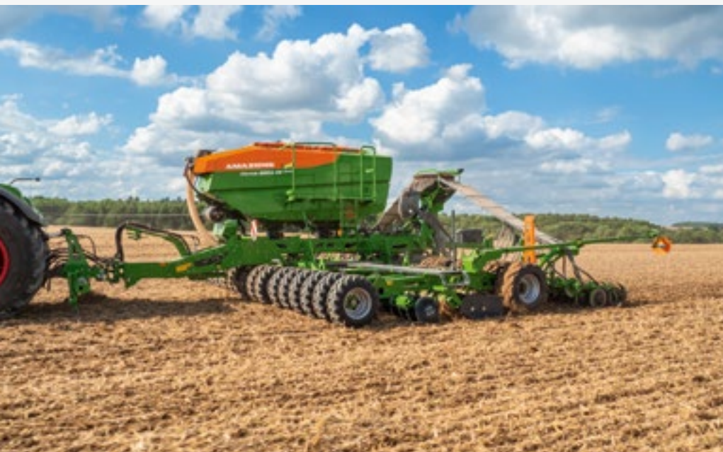
Cirrus 9004-2C Grand со следорыхлителем при посеве промежуточных культур
