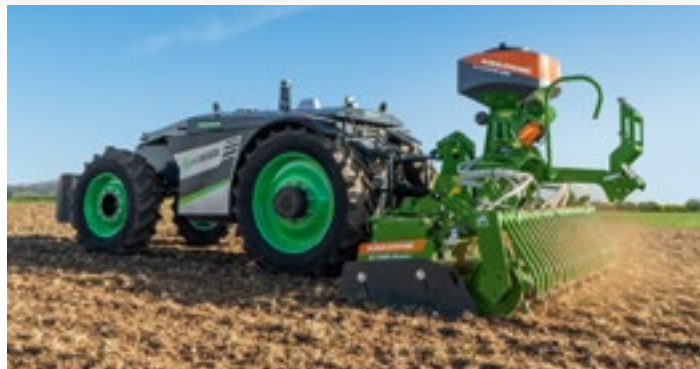
4-колесный AgXeed AgBot и ротационная борона AMAZONE KE 3001 Super с насадной сеялкой GreenDrill
