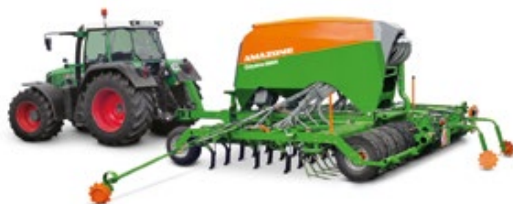
Cayena 6001: 36 долотовидных сошников, междурядье 16,6 см – рабочая скорость до 15 км/ч
