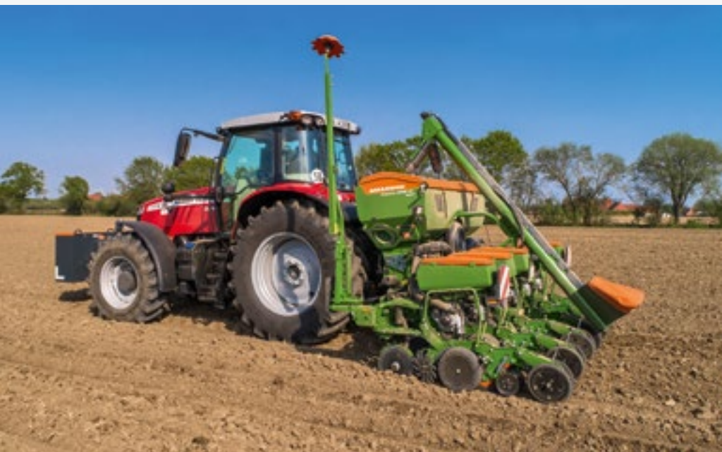
Насадная сеялка точного высева Precea 4500-2CC, 6-рядная
