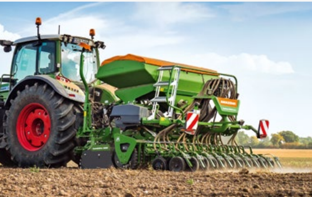
Centaya 3000 Super с двухдисковыми сошниками TwinTeC
