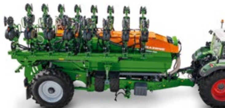
Precea 12000-TCC в сложенном состоянии с транспортной шириной 3 м
