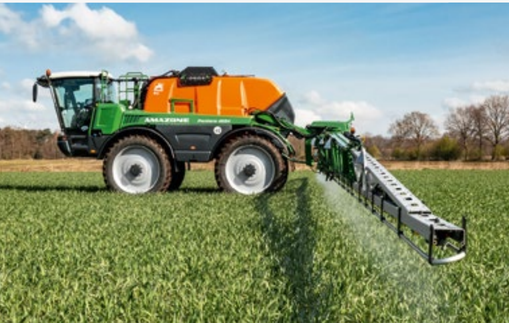
Самоходный опрыскиватель Pantera 4504 с клиренсом 1,2 м
