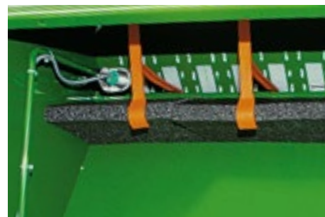
Оptionальная вставка для рапса легко устанавливается в семенной бункер для уменьшения остатков.
