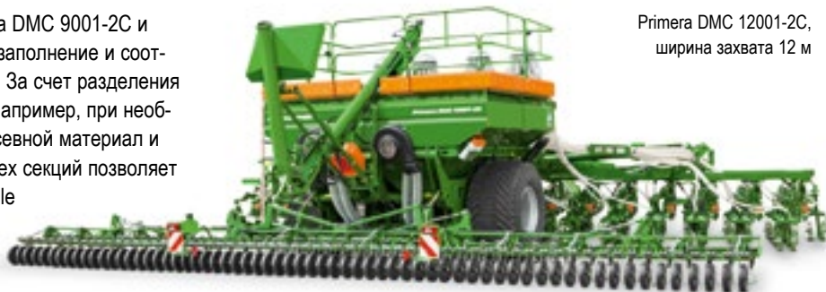
Primera DMC 12001-2C с шириной захвата 12 м с расположенными снаружи распределительными головками
