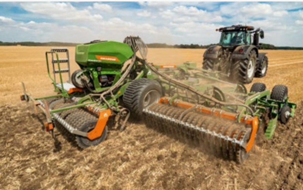
Компактная дисковая борода Catros XL 8003-2TX с универсальной насадной сеялкой GreenDrill 501
