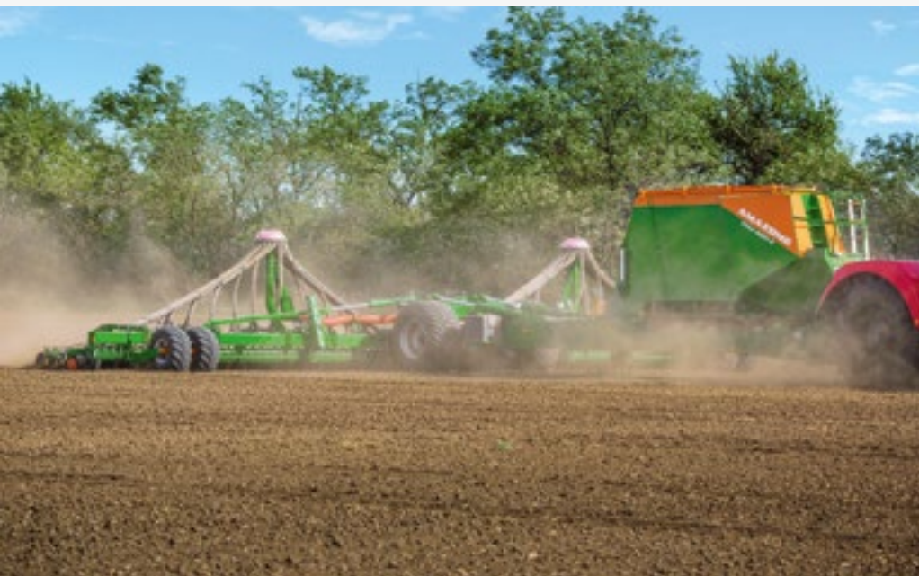
Citan 12001-C, стандартно с трехсекционным бункером
