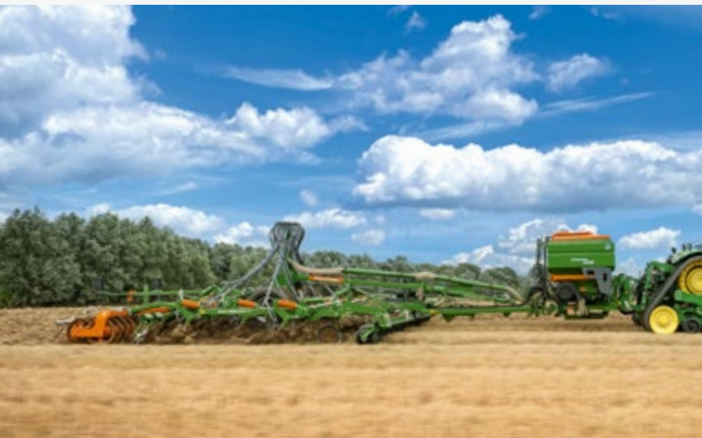
XTender 4200 с Cenius 7003-2TX и двумя магистралями подачи для внесения удобрений и посевного материала
