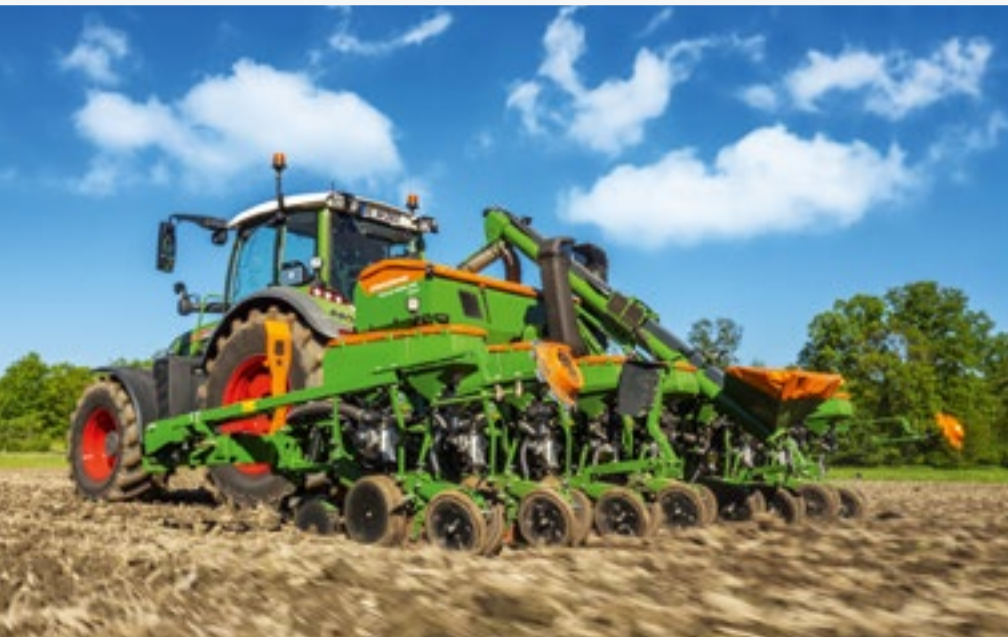
Сеялка точного высева Пресеа 6000-2CC, 8-рядная, в работе
