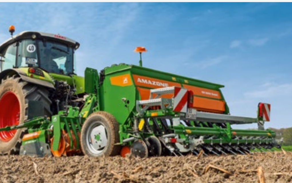
D9 3000 Super со штригелем Exakt в комбинации с ротационной бороной и зубчатым катком
