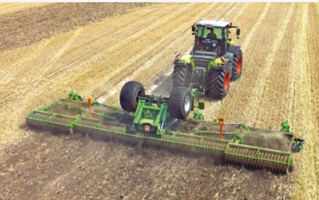
Catros + 12003-2TS с шириной захвата 12 м при лушении стерни
