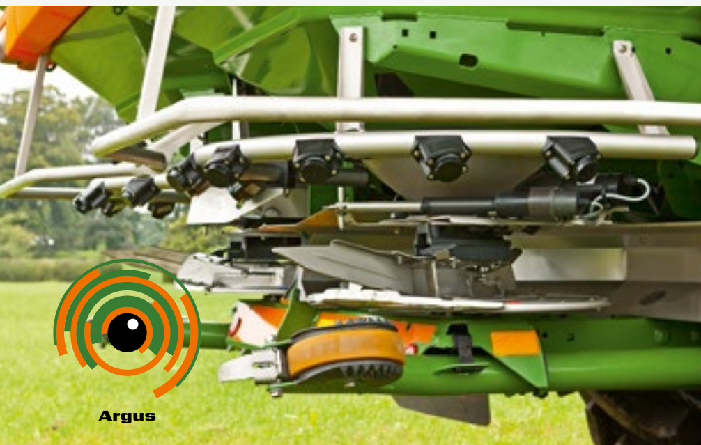
Навесной распределитель ZA-TS с системой ArgusTwin
