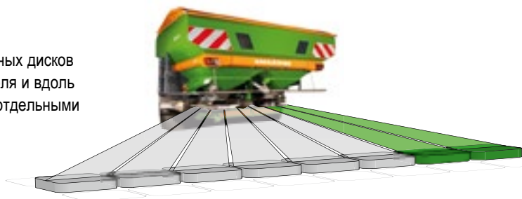
С 8- или 16-кратным посекционным включением для ZA-V можно управлять отдельными секциями, расположенными снаружи
