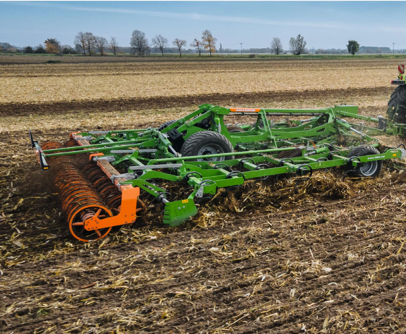
Der 6-balkige Flachgrubber Cobra mit Arbeitsbreiten von 6 m und 7 m bietet viele Einsatzmöglichkeiten. Vom Zwischenfruchtumbruch, dem flachen Stoppelsturz bis zur Saatbettbereitung ist der Cobra ein Allrounder für die flache Bodenbearbeitung. Durch ein vielfältiges Vorwerkzeug-, Schar- und Walzenprogramm lässt sich das Gerät an nahezu alle Standortverhältnisse anpassen.
