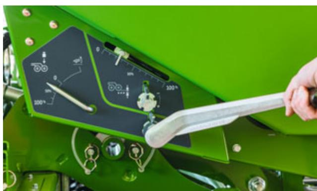
Zentrale stufenlose mechanische Schardruckverstellung mit Skala der Cataya Super
