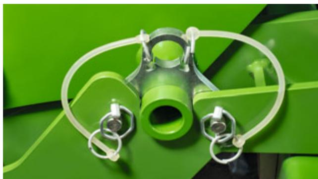
3 gut zugängliche Kupplungspunkte des Schnellkuppelsystems QuickLink sorgen für einen sicheren, werkzeuglosen und schnellen An- und Abkuppelvorgang.
