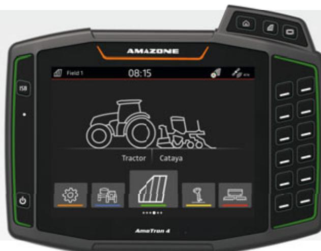
Das von AMAZONE selbstentwickelte ISOBUS-Bedienterminal AmaTron 4 erlaubt die komfortable Steuerung einer jeden ISOBUS-fähigen Landmaschine mit Touch-Bedienung. Das AmaTron 4 ermöglicht dabei alle ISOBUS-Funktionen – mit einem Mehr an Komfort, Bedienerfreundlichkeit und Übersicht. Und doch: Es leistet insbesondere im Zusammenspiel mit AMAZONE Landmaschinen noch mehr und garantiert volle Funktionalität der Präzisionslandwirtschaft.
