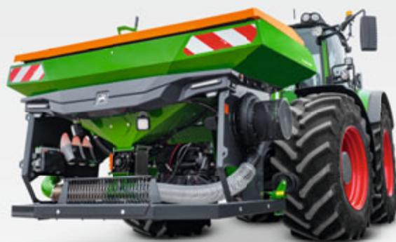
FTender 1600 mit geschlossenem Fördersystem als Druckbehälter mit Behälterdeckel für hohe Fördermengen
