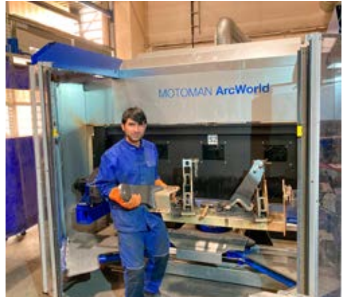
Hamidullah Ahmazaye megtölti a hegesztőrobot berendezését
