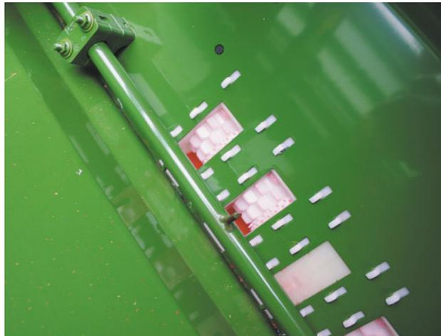
Bild 2: Blick in den Saatgutvorratsbehälter mit Rührwelle, Normal- und Feinsärädern.
