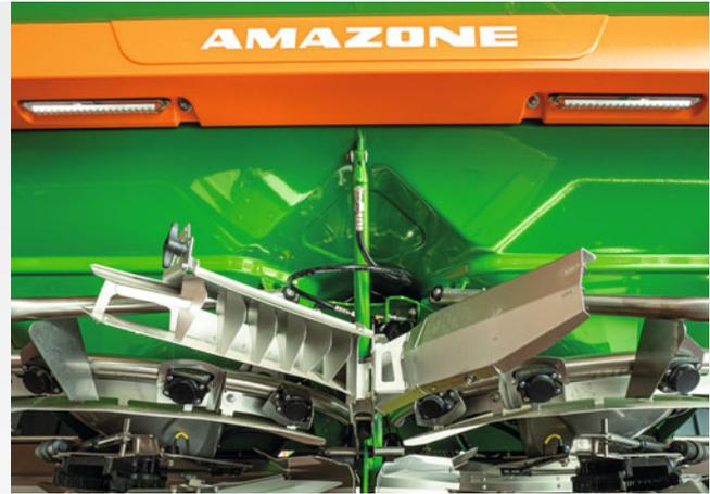
Die Streuwerksbeleuchtung ist sicher in den Beleuchtungsträger integriert – hier am ZA-TS mit BorderTS-Schirm und ArgusTwin.
