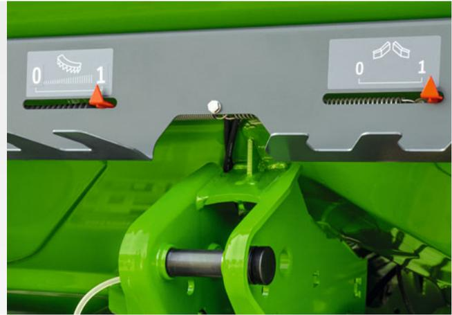
Positionsanzeige des Limiters (links) und die Positionsanzeige des Beetstreuerschirms bzw. Grenzstreuerschirms (rechts)
