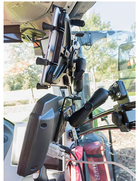
Für das GPS-ScenarioControl wird ein Tablet mit AmaTron Twin-App gebraucht. Dieses lässt sich mit der RAM-Halterung von Amazone für 205 Euro direkt am AmaTron 4-Terminal befestigen.
