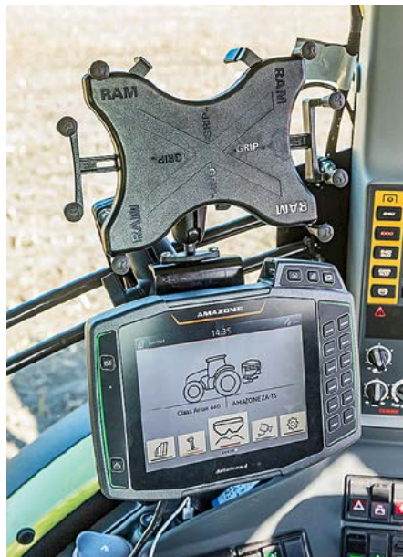
Für das GPS-ScenarioControl wird ein Tablet mit AmaTron Twin-App gebraucht. Dieses lässt sich mit der RAM-Halterung von Amazone für 205 Euro direkt am AmaTron 4-Terminal befestigen.
